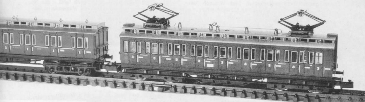
N Abb. 10 u. 11. Der Oldtime-Triebwagen ET 88 auf Abteilwagen-Basis. Das 10,6 cm lange Arnold-Modell wird auf allen vier Achsen angetrieben; ein Triebzug besteht normalerweise aus Trieb- und Steuerwagen sowie einem oder mehreren Abteil-Zwischenwagen (siehe dazu MIBA 10/79, S. 786).
