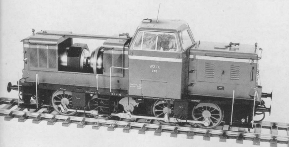
Abb. 57. . . . statt des Diesel- einen Elektromotor aufweist. Unter der geöffneten Haube sieht man hier den Elektromotor und anschließend das hydraulische Getriebe, das weiter auf ein Übersetzungsgetriebe und die Blindwelle wirkt. Im rechten Vorbau ist der Stellmotor für die voll funktionsfähige Bremsanlage untergebracht.
