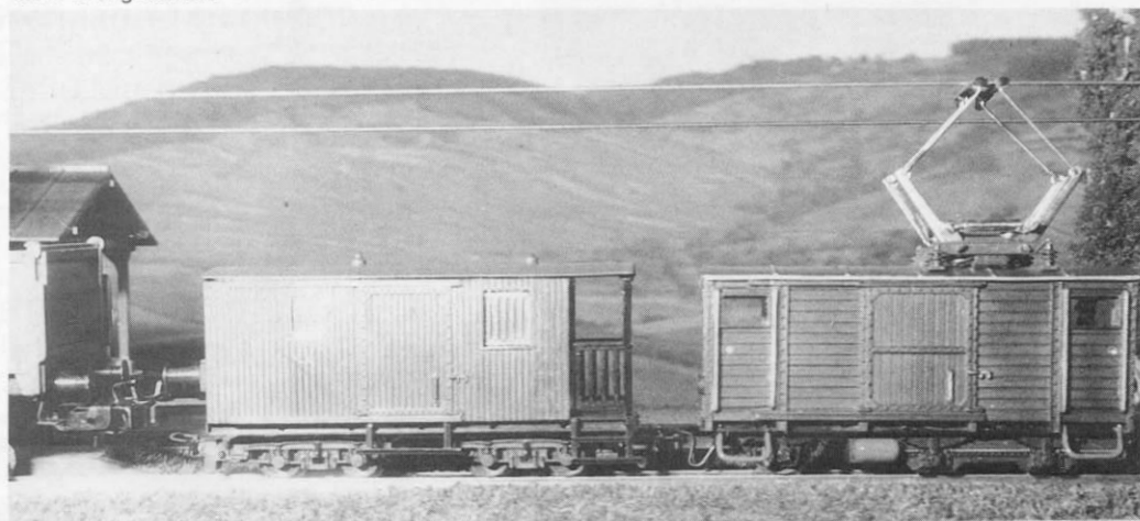
Abb. 10. Seitenansicht des Gepäcktriebwagens (s. Abb. 5); der Zwischenwagen für den Rollbockbetrieb läuft auf N-Drehgestellen.
