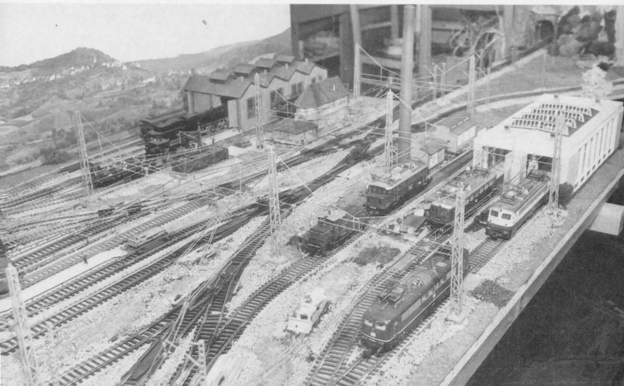
Abb. 3. Die Weichenstraßen des Bahnhofs mit den farblich nachbehandelten und dadurch weniger auffallenden Weichenantrieben. Im Hintergrund führt die Strecke über ein klappbares Anlagenteilstück (siehe Abb. 5–7) zum Hauptteil der Anlage.
