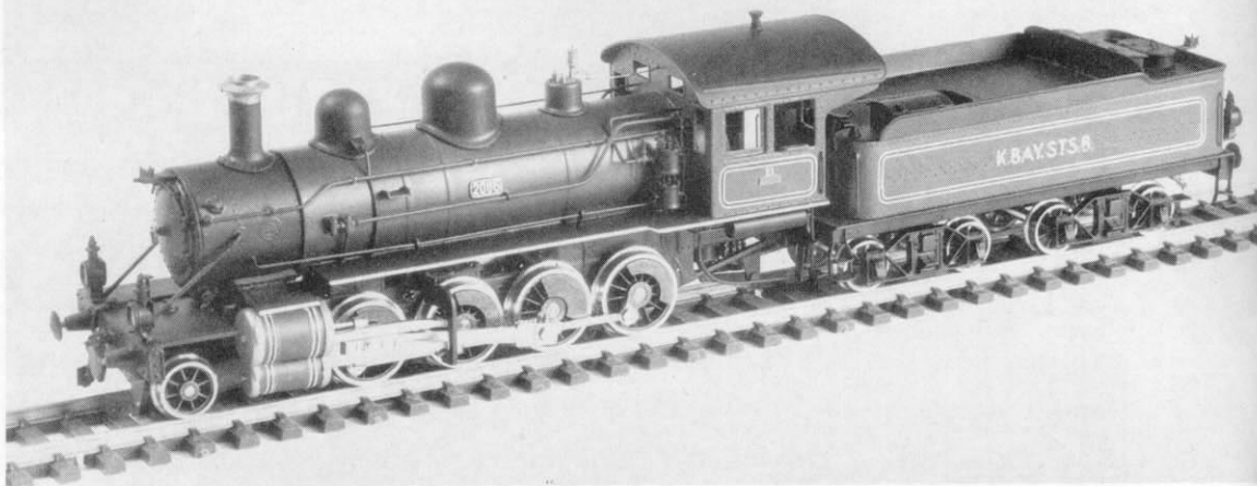
Amerikanische „Stilelemente“ (wie die Ausführung von Zylindern, Führerhaus und Tender) vereint mit bayerischen „Zutaten“ (wie dem Kranzschornstein): die bayerische El-Güterzuglok als Fulgurex-H0-Modell.
