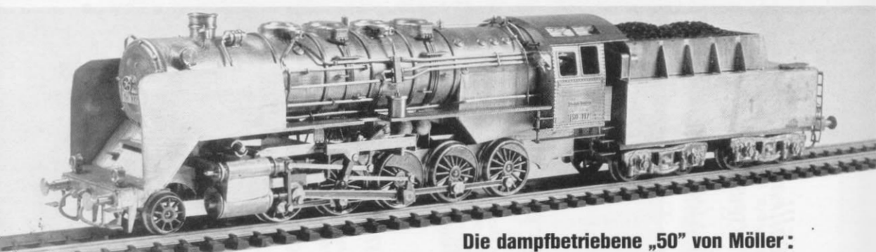
Abb. 2. Das ganz aus Messing gearbeitete H0-Modell der „50“; das „live steam-Innenleben“ ist dem exakt detaillierten Modell nicht anzusehen.
