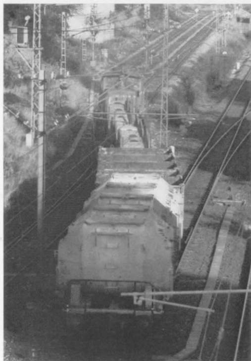
Abb. 4-6. Der Wendevorgang im Kkehrbahnhof: Ein Nahgüterzug aus Richtung Kornwestheim fährt in das Kehrgleis ein; die Lok setzt unter Benutzung des kurzen Zieh- bzw. Schutzgleises um und fährt nach dem Zurücksetzen und dem Umstellen der Weiche mit dem Zug ab. Die Abbildungen zeigen den Kkehrbahnhof übrigens während des Umbaues, wie an der Gleisverbindung in der Hauptstrecke (vgl. Abb. 3 u. 8) erkenntlich ist.
