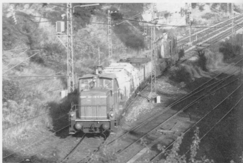
Abb. 4-6. Der Wendevorgang im Kkehrbahnhof: Ein Nahgüterzug aus Richtung Kornwestheim fährt in das Kehrgleis ein; die Lok setzt unter Benutzung des kurzen Zieh- bzw. Schutzgleises um und fährt nach dem Zurücksetzen und dem Umstellen der Weiche mit dem Zug ab. Die Abbildungen zeigen den Kkehrbahnhof übrigens während des Umbaues, wie an der Gleisverbindung in der Hauptstrecke (vgl. Abb. 3 u. 8) erkenntlich ist.
