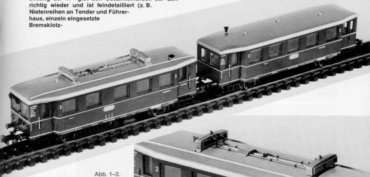
Abb. 1–3. Der Nebenbahntriebwagen VT 75 mit den fein ausgeführten Dachleitungen und den beiden Motor- kühlern. Der Beiwagen VB 140 trägt übrigens nur ein Schlußlicht.
