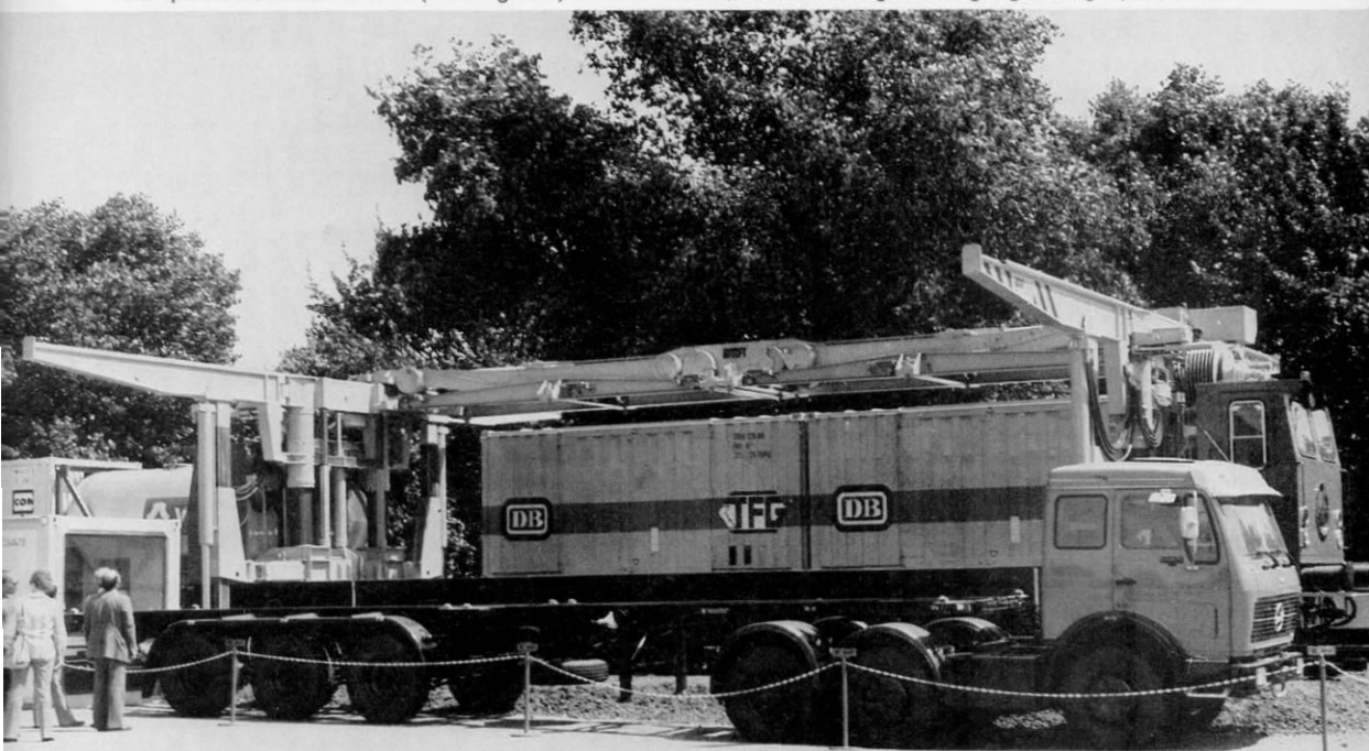
Abb. 67. „ Container bitte umsteigen “ heißt es beim neuen Container-Umschlag-Gerät „ULS“; es handelt sich dabei um ein schienenfahrbares Gerät, das den Container horizontal von einem Tragwagen auf den anderen, eine Rampe oder auch auf LKW's (Vordergrund) umsetzen kann, wodurch Rangierbewegungen eingespart werden.
