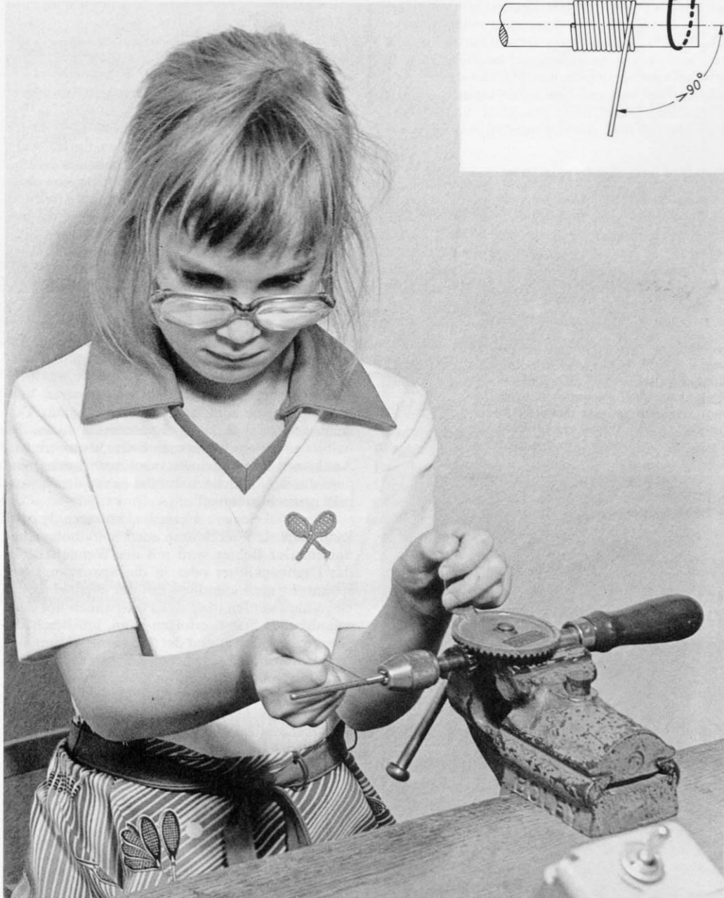
Abb. 6. u. 7. Ganz konzentriert bei der Sache: Birgit, die 8jährige Tochter des Verfassers, demonstriert hier das Wickeln einer Zugfeder mittels einer in den Schraubstock eingespannten Handbohrmaschine. Wichtig: Der Draht muß stets leicht schräg zugeführt werden (siehe Skizze).
