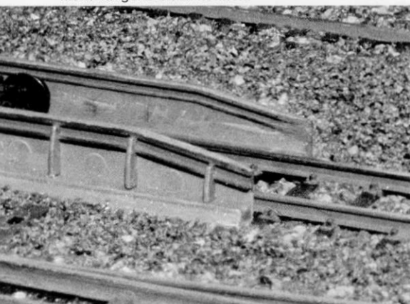
Abb. 5. Die Rollbockgrube hat innen schräg angefeilte Schienenenden des Normalspur-Gleises, damit die Rollböcke beim Einlaufen in die Rollbockgrube nicht hängenbleiben können.
