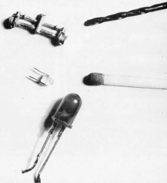
Abb. 4. Laternen (am Spritzling), 1,5 mm-Bohrer, 1,8 mm-LED und vergleichshalber eine 5 mm-LED sowie ein Streichholz, das zum Umbau indes nicht benötigt wird (haha!).
