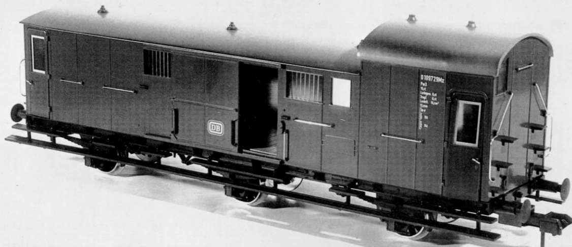
Abb. 2. Das 39 cm lange I-Modell eines dreiachsigen Gepäckwagens preußischer Bauart.
