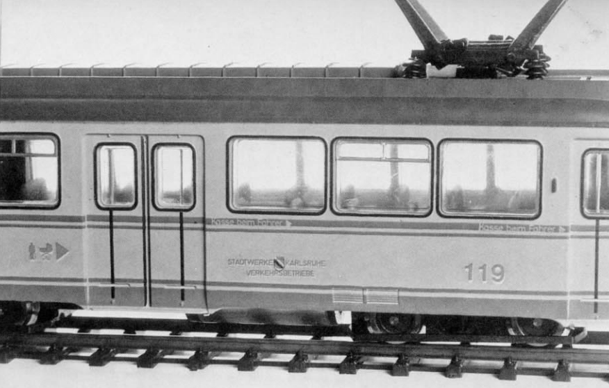
Abb. 3. Der tief eingebaute N-Motor macht sich im Innenraum nicht störend bemerkbar. Die Beschriftung liegt in Abziehbildform bei.
