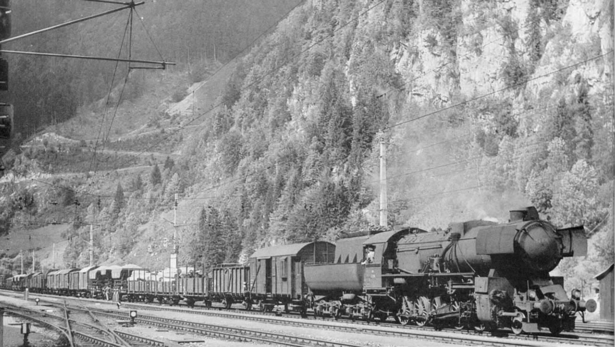
Abb. 4. Die 52.836 der ÖBB in Hieflau, ausgestattet mit Normalkamin samt Klappdeckel, Witte-Windleitblechen und Wannentender ohne Zugführerkabine – eine der Varianten, die Märklin aus seiner 50er entwickeln konnte. Weitere Möglichkeiten: BR 50 ÜK (Übergangs-Kriegslok) und die Baureihen 50 35 , 50 40 oder 52 90 der DR. Angesichts der vielen Varianten würden sich den Kleinserienherstellern zahlreiche Möglichkeiten eröffnen.
