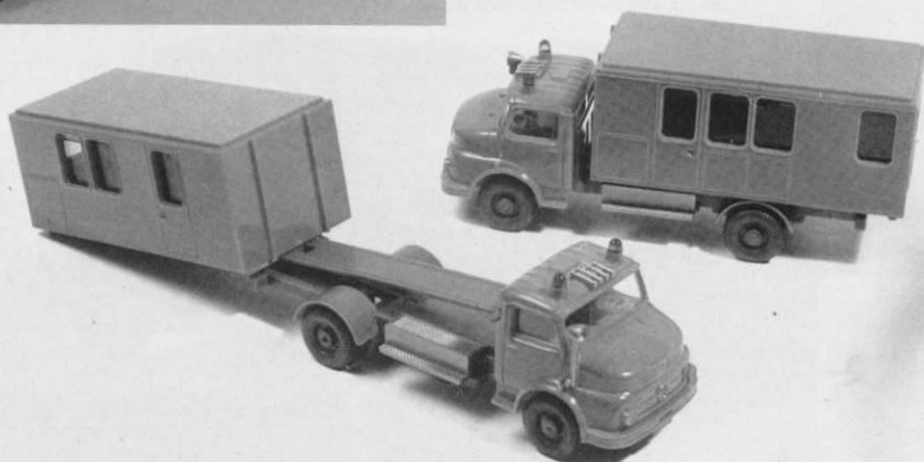
HO Abb. 339. Der Kasten Aufbau des Feuerwehrwagens vom Typ „AS“ läßt sich über die Kipprampe absetzen.
