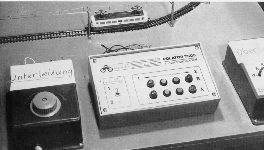
Ilm-Z Abb. 109. Für alle Bau-Größen geeignet ist das Kehrschleifen-Steuergerät „Polator“, das auch „elektrotechnischen Laien“ den polaritätsmäßig problemlosen Aufbau und Betrieb von Kehrschleifen und Gleisdreiecken im Zweischienen-Gleichstromsystem (auch mit Oberleitung) ermöglicht.
