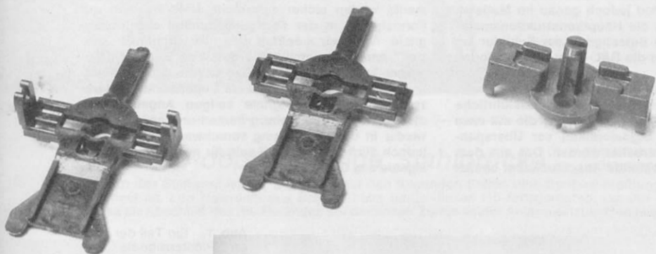
Abb. 3. Links ein Original-Drehschemel von Ade, in der Mitte ein bearbeiteter Ade-Drehschemel und rechts ein Roco-Drehschemel.
