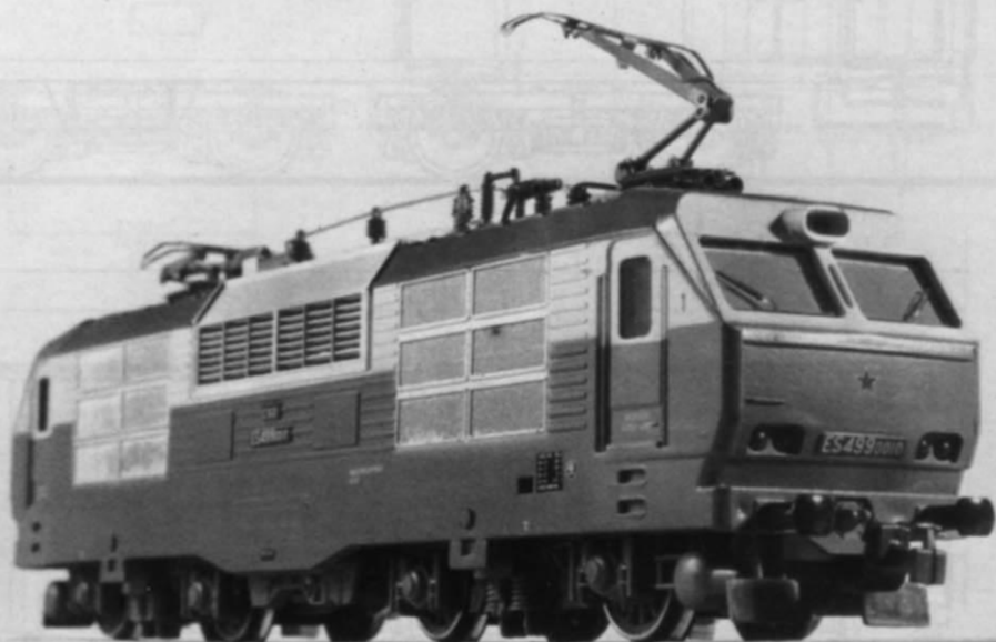
Abb. 2. Die für unsere Augen ungewohnte, kantige Stirnpartie und weitere Details des Modells (dessen Dreispitzenlicht mit der Fahrtrichtung wechselt).
