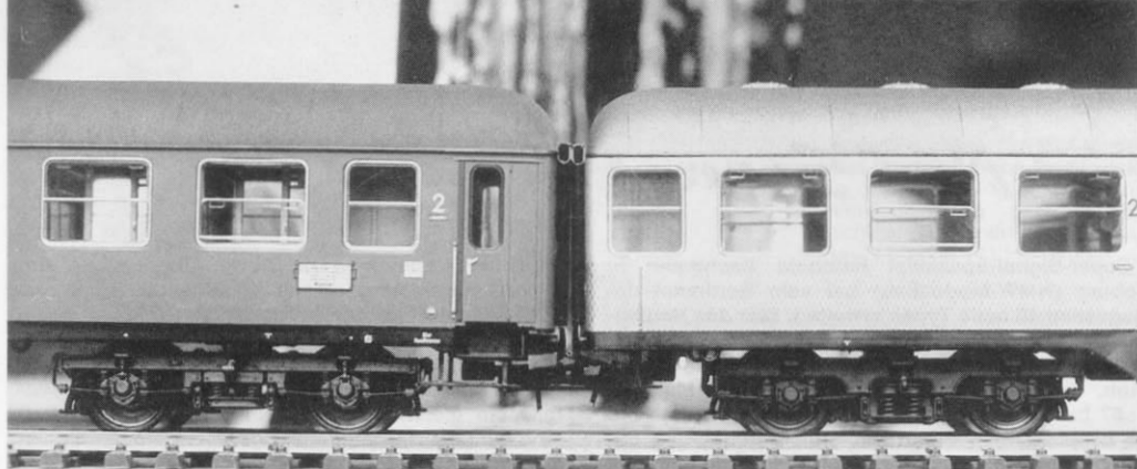
Abb. 1 zeigt vergleichshalber links einen Ade-Schnellzugwagen mit „Minden-Deutz 50“-Drehgestell, rechts einen Ade-Nahverkehrswagen mit einem „Minden-Deutz leicht“-Drehgestell.
