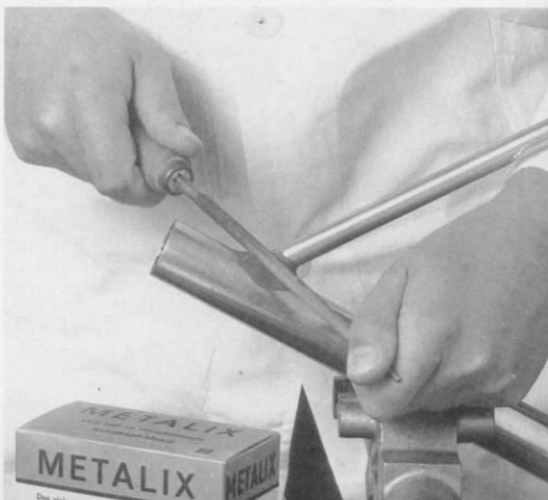
Abb. 5. ... wie normales Metall bearbeitet werden (bohren, drehen, feilen, schleifen usw.). Fotos Abb. 3–9: Delo GmbH, München.
