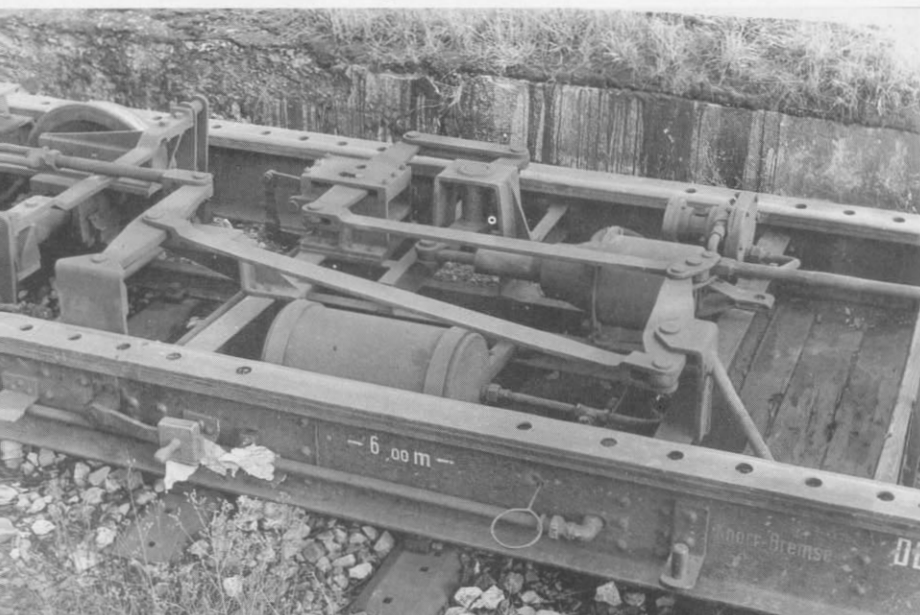
Abb. 66. Für Nachbau-Interessenten: Details von Bremszylinder und -gestänge usw. an einem Mosbach-Mudauer Rollwagen.
