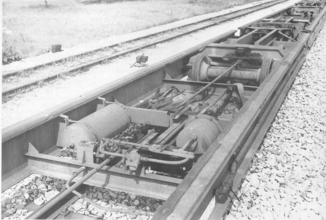
Abb. 67. Wer den MEG-Rollwagen nachbauen möchte, kann dieser Abbildung zahlreiche Details von Rahmenkonstruktion, Bremsanlage usw. entnehmen.
