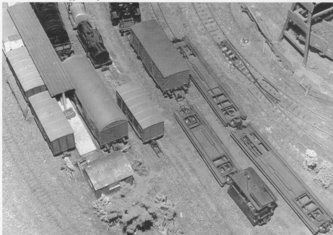
Abb. 49. ... mittels eines Triebfahrzeugs mit Fernentkupplung erfolgen muß, wie sie die am oberen Bildrand gerade noch hervorspitzende Märklin-86 hat. Der Vollspurwagen wird hier also in Richtung Rollwagen geschoben; den die Schmalspurlok gegen die Rampe drückt. Gleichzeitig zeigt diese Abbildung die zwei unterschiedlich langen Rollwagen der Herren Gunzenhäuser (für unterschiedliche lange Vollspurwagen), die diese u. a. aus Faller-Profilen und Egger-Drehgestellen bastelten.
