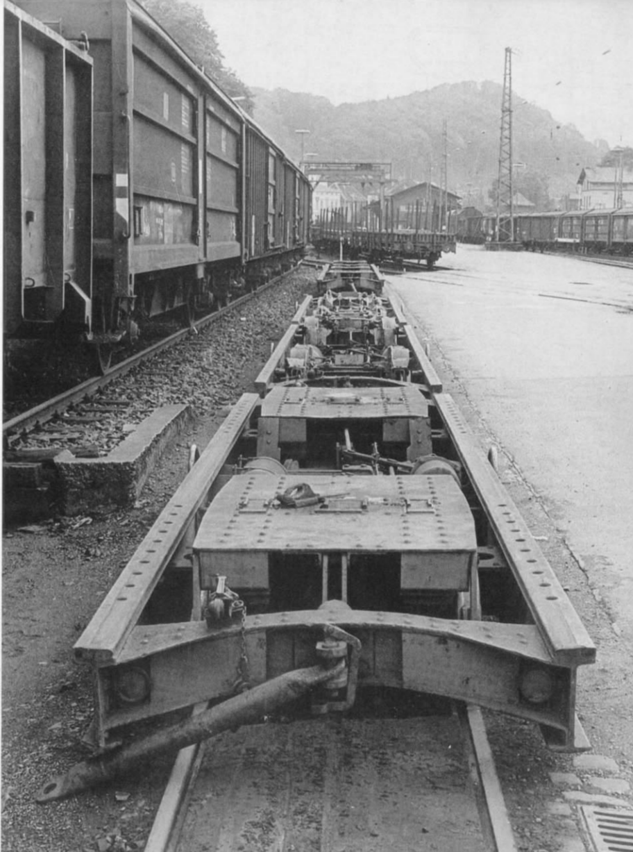
Abb. 55 u. 56 zeigen vergleichsweise die zwei unterschiedlichen Kupplungsarten von Rollwagen beim Vorbild: unten ein Rollwagen mit normaler Schmalspur-Kupplung (dem geeigneten Modellbahn-Vorbild), rechts ein solcher mit Deichsel-Kupplung (siehe Haupttext). Gleichzeitig zeigt der rechte Rollwagen eine im Hinblick auf den Modell-Nachbau interessante Abdeckung (wodurch z. B. auch im Kleinen eine Drehgestell-Lagerung von oben – vgl. Abb. 71 – verdeckt werden kann).
