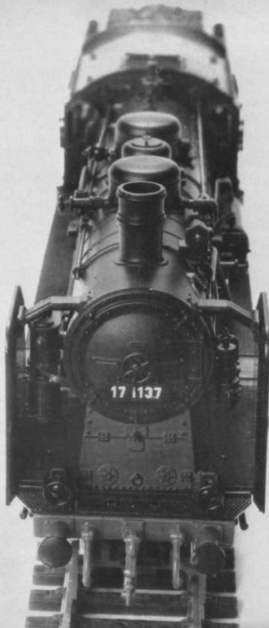
Abb. 5 u. 6. Oben: Stirnansicht des S 10 1 -Modells mit der genauen Nachbildung der Pumpen beiderseits der Rauchkammer und der Schürze vor dem Innentriebwerk. Rechts: die Detaillierung der Lokunterseite und des Führerstands.
