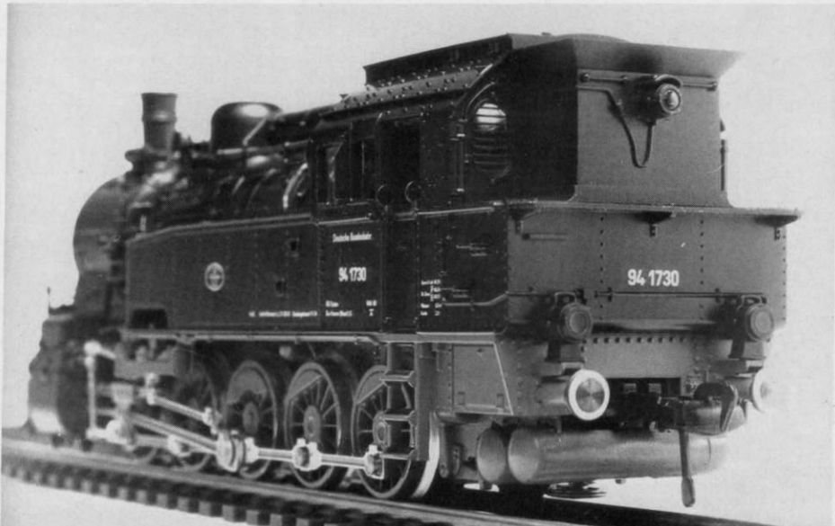
Abb. 7. Rückansicht des Modells mit den feinen Schutzgittern vor den Fenstern, den Vorbildgetreu unterschiedlich ausgeführten Lampen samt Zuleitungskabeln und Befestigungsschellen u. v. m.
