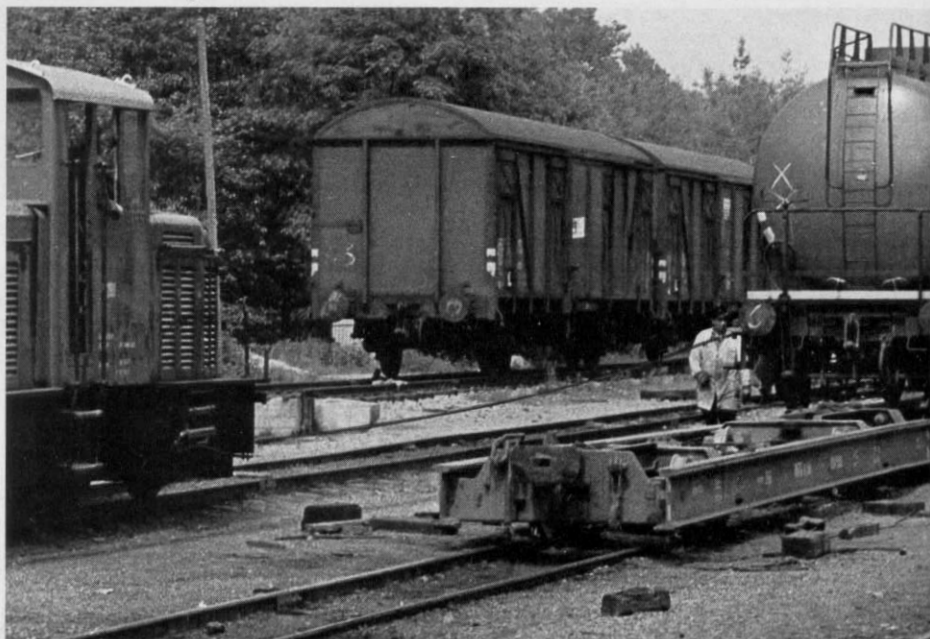
Abb. 35. Diese Ausschnittvergrößerung aus dem obigen Foto zeigt deutlich die Seilverbindung zwischen Schmal-spurloks und Kesselwagen.
