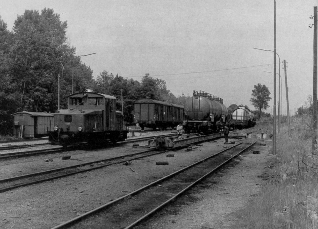
Abb. 34. Ein Umsetzvorgang an der Rollwagen-Rampe im Übergabebahnhof Rastatt der MEG. Die Schmal-spurloks V 2901 (ex DB) zieht eben die beiden Kesselwagen mit einem Seil auf die zwei Rollwagen.
