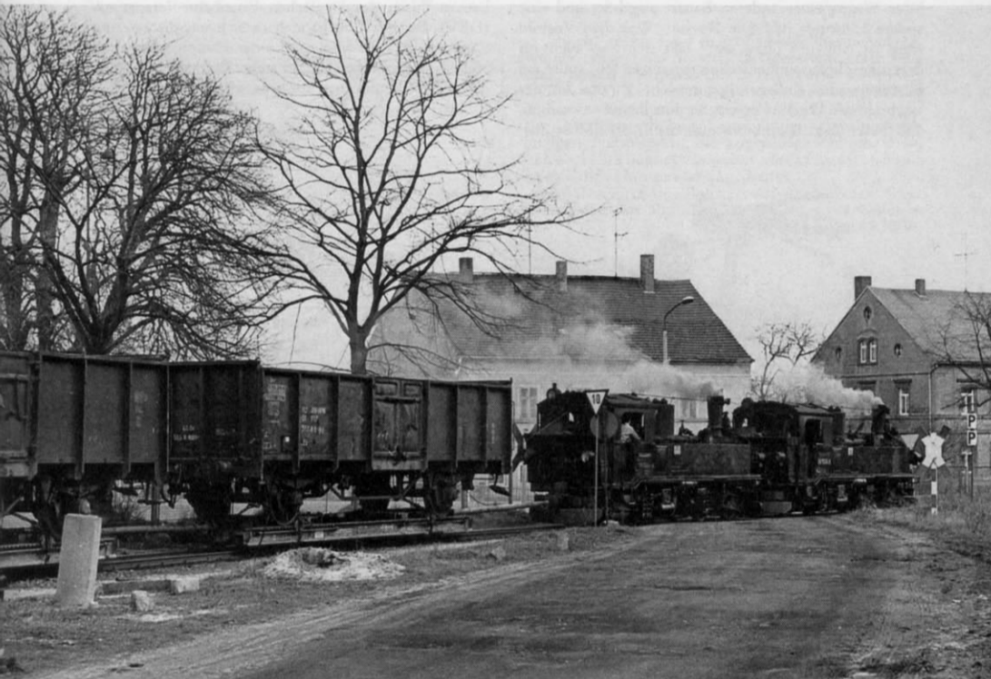
Abb. 37. Ein von zwei Meyer-Dampfloks gezogener Rollwagenzug bei der Deutschen Reichsbahn, bei dem man die langen Kuppelstangen zwischen Lok und ersten Wagen und die etwas kürzeren Kuppelstangen zwischen den Rollwagen beachte (s. Haupttext).
