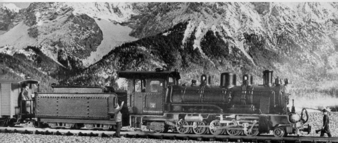
Abb. 2 u. 3. Der „jüngste Sproß“ des selben Modellbauers: ein superdetailliertes H0e-Modell einer Schmalspurlokomotive (Minitrix-52-Fahrwerk, Aufbau aus Vollmessing und Messingblech). Das Vorbild ist eine 1'E1'-Lok der Heeresfeldbahnen, wie sie damals auf fast allen Kriegsschauplätzen – sicher auch vor einer ähnlichen Kulisse wie auf Abb. 3 – zu finden war.
