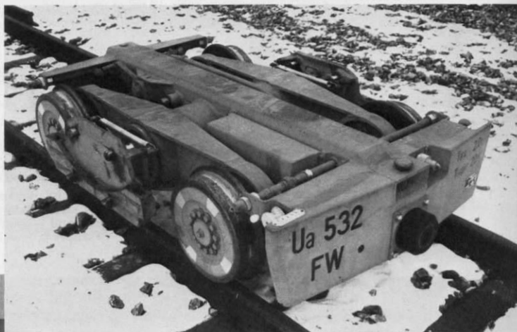
Abb. 22. Kennzeichen des neuentwickelten Vevey-Rollbock sind u. a. eine niedrige Bauhöhe, eine drehbar gelagerte Lasttraverse (die das Befahren enger Kurven ermöglicht) und eine verstellbare pneumatische Radbremse.
