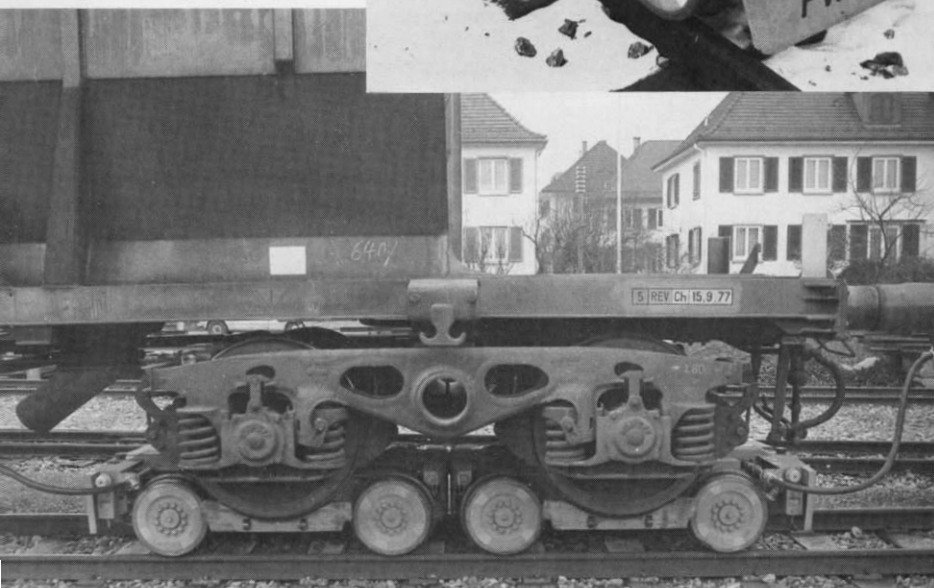
▼ Abb. 23. Nahansicht eines auf zwei Vevey-Meterspur-Rollböcken aufgebockten Güterwagen-Drehgestells vom Typ Y 25; hier wird die niedrige Bauhöhe besonders deutlich. Außerdem erfordert das Vevey-Rollbocksystem nur sehr kurze Umsetzzeiten (ca. 2–3 Minuten pro Wagen oder Wagengruppe).
