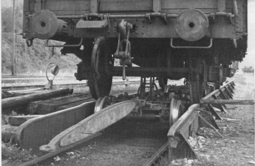
Abb. 18 zeigt im Vordergrund einen Rollbock mit noch nicht aufgestellten Achsgabeln und einer Verbindungsdeichsel, mit der unbeladene Rollböcke verbunden werden (und die sich hier noch zu Rangierzwecken am Rollbock befindet).
