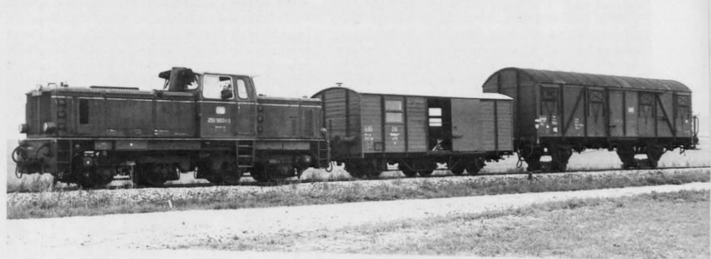
Abb. 4. Das Gegenstück zum langen Güterzug der Abb. 3: ein Kurz-Rollbock-Zug, wie er im Kleinen mit den entsprechenden Bemo-Modellen und einem H0-Güterwagen genau authentisch „nachgestellt“ werden kann. Diese Vorbildaufnahme stammt ebenfalls von der Schmalspurstrecke Ochsenhausen–Warthausen.
