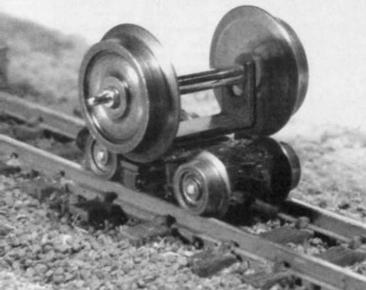
Abb. 8 zeigt, daß bei den Bemo-Rollböcken die Spurkränze der Vollspurräder wie beim großen Vorbild (Abb. 9) auf Auflegern aufliegen; die Achsgabeln verhindern ein „Täumeln“ der aufgeböckten Wagen.
