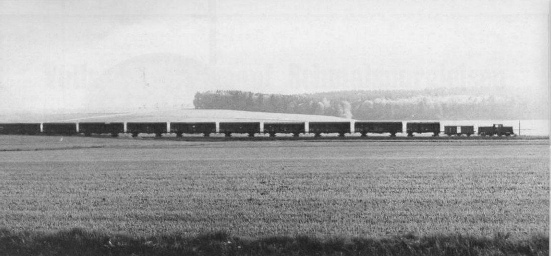
Abb. 3. Einen aus 10 aufgebockten G-Wagen bestehenden Güterzug (samt Zwischenwagen) schleppt hier die 251-Diesellok hinter sich her (auf der 750 mm-Schmalspurstrecke Ochsenhausen–Warthausen, die heute noch in Betrieb ist). Im Großen ist die Zahl der auf Rollböcken mitgenommenen Vollspurwagen lediglich durch die sog. „Lastentafel“ begrenzt (eine Tabelle, die angibt, welche Höchstlasten auf welchen Strecken befördert werden können); im Kleinen begrenzen die Zugkraft der Schmalspurloks sowie gewisse Streckenverhältnisse (enge Radien, Steigungen) ohnehin die Zahl der aufgebockten Wagen!
