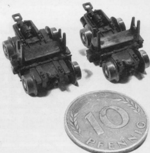
Abb. 5. Zwei Bemo-Rollböcke, links die H0m-Ausführung (12 mm Spurweite) und rechts die H0e-Ausführung (9 mm Spurweite). Der Größenvergleich mit dem Groschen zeigt die weitgehende Detaillierung (inkl. Bremszylinder-Imitation) der Bemo-Modelle.
