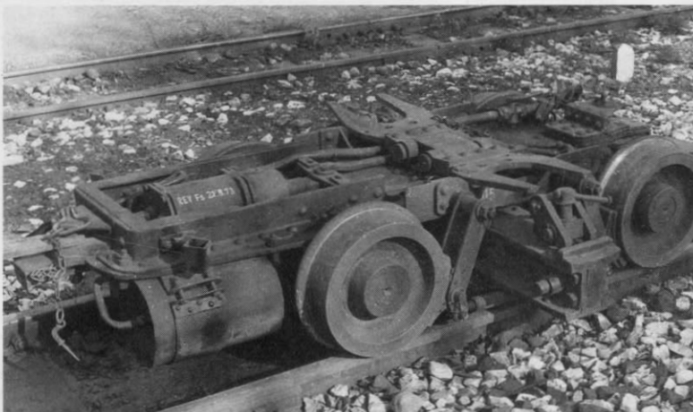
Abb. 7. Ein gebremster 750 mm-Rollbock der DB aus anderer Sicht. Deutlich zu erkennen sind der Drehschemel mit der Auflage für die Spurräume des Vollspurwagens sowie die heruntergeklappten Achsgabeln und die beiden Bremsluftbehälter; das Bremsgestänge mit den Bremsbacken ist zu beiden Seiten des Drehschemels zu sehen.
