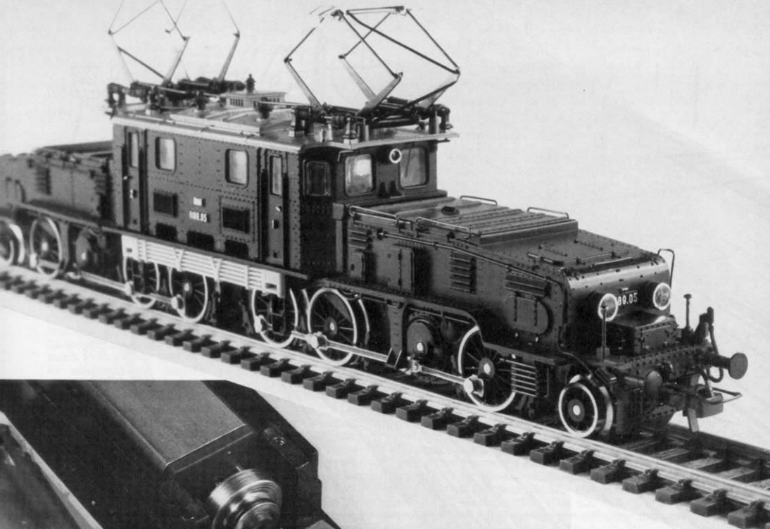
Abb. 1 u. 2. Unter den maßstäblichen schmalen, superdetaillierten Vorbauten des 1189-Modells befinden sich Ballastgewichte, in die jeweils zwei Glühbirnen (siehe Haupttext) eingebettet sind. Gut zu erkennen: eines der Schwungräder mit der Gummiring-Kraftübertragung zum Getriebe.
