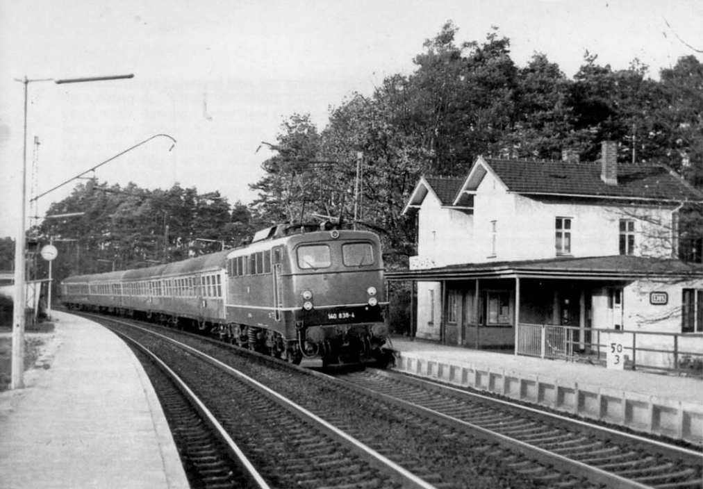
Abb. 1. Preisfrage: In welcher Richtung fährt dieser Zug? – Antwort: von rechts nach links, also vom Betrachter weg, wie an der Pantographen-Stellung der diesen Wendezug schiebenden Ellok zu erkennen ist. Hier sehen wir übrigens eine ausgesprochen typische Wendezug-Garnitur aus Ellok 140 (E 40) und „Silberling“-Nahverkehrswagen. (Foto: Walter Schier, Nördlingen)
