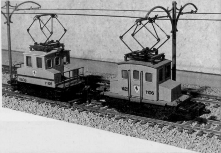
Abb. 7. Ein Zug aus Trieb- und Beiwagen in sog. „Niederflur“-Bauweise (Aufbauten aus 1 mm-Plastikplatten von Graupner, Fahrwerk von Liliput).
