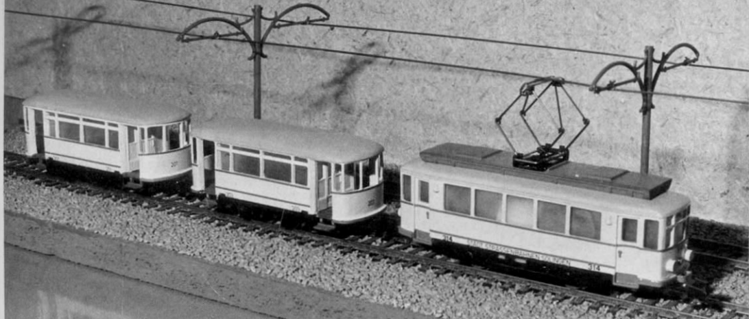
Abb. 9. Ein Strab-Zug, der einem Solinger Vorbild nachempfunden wurde. Der Triebwagen entstand durch Umbau des Hamo-Modells T 206 und erhielt u. a. neue Fensterstreben, Zielangabe und zwei Frontlampen.
