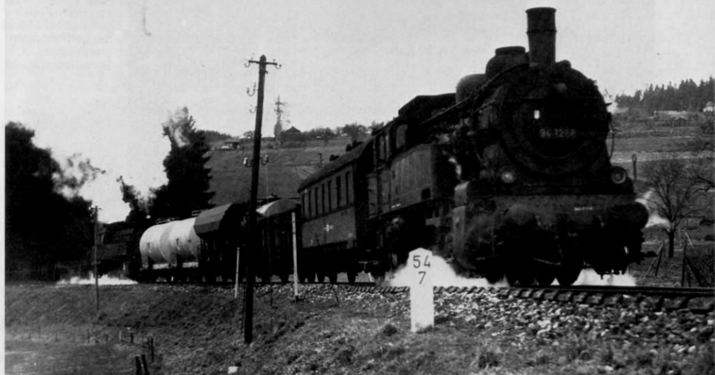
Abb. 10. Dieses Vorbildfoto beweist, daß keineswegs nur längere Züge nachgeschoben werden: dieser 6 Wagen-Nahgüterzug braucht zwei Lokomotiven für die 5%-Rampe zwischen Freudenstadt-Bahnhof und Freudenstadt-Stadt – eine gute Anregung (und „Ausrede“) für den Modellbahn-Schiebebetrieb mit kurzen Zügen!
