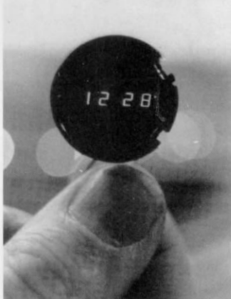
Abb. 2. In ca. \frac{1}{1} Originalgröße wiedergegeben: das komplette Uhrenmodul.
