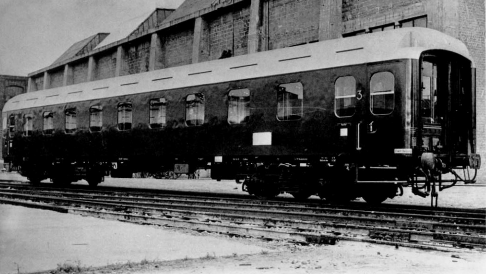
Abb. 1. Der in der heutigen Bauzeichnung dargestellte Probe-Schnellzugwagen vom Typ BC 4üwe-51, hier noch vor der Umzeichnung (nach dem Fortfall der 3. Klasse im Jahre 1956) aufgenommen; die Zeichnung zeigt den Wagen mit der Beschriftung nach 1956 (Foto: Sammlung J. Deppmeyer, Uelzen).
