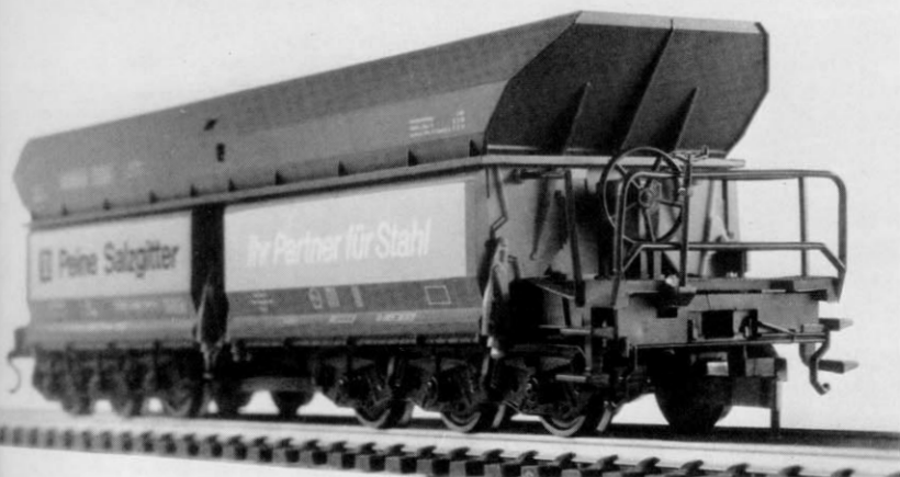
Abb. 2. Das Roco-Modell des Erzwagens Fad 150 von der Bühnenseite (mit dem Bedienungshandrad für die Entladeklappen) her gesehen.
