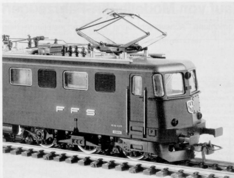
Abb. 4. Die Frontpartie des Ae 6/6-Modells weist zahlreiche Details auf. Unter dem abnehmbaren „Lüftungsauflauf“ (links vom Pantographen) sitzt der auf Abb. 2 „vorgeführte“ Umschalter Oberleitung/Unterleitung!
