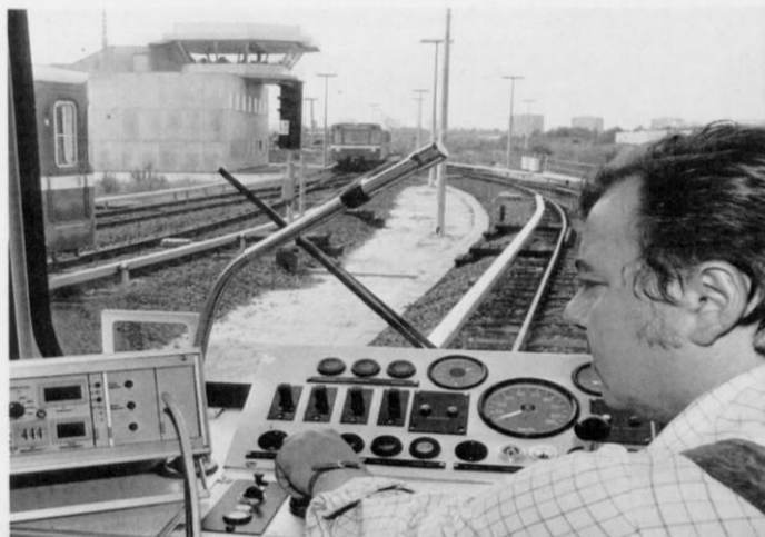
Abb. 5. Das Original-Foto zur Abb. 1, ohne die von uns hineinmontierte Digital-Anzeige des Modellbahn-Tachos. Das Gerät links ist in Wirklichkeit ein neuentwickelter Bremswegmesser für elektronisch gesteuerte Triebwagen; daß es sich nicht um den Tacho handelt, dürften aufmerksame Leser schon am „echten“, auf „0“ stehenden Tacho erkannt haben, dem runden Anzeige-Instrument links vom Gesicht des Lokführers.
