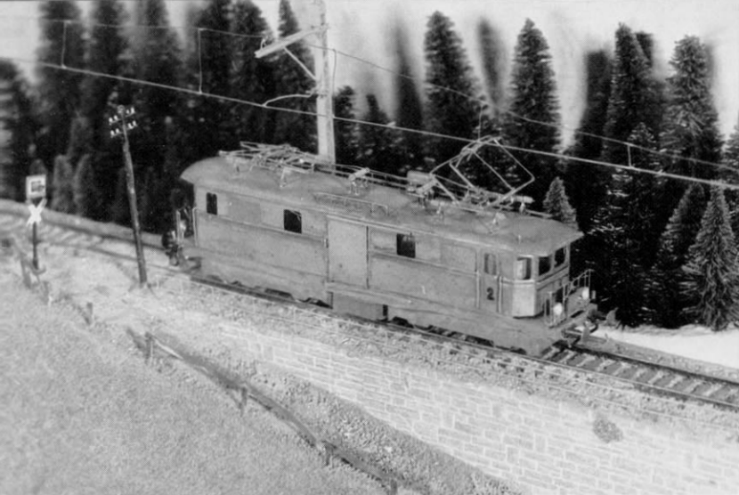
Abb. 1. Das selbstgebaute H0-Modell einer ÖBB-Gepäcklokomotive, dessen Pantographen mit der Bügelmotorik gehoben und gesenkt werden können.
