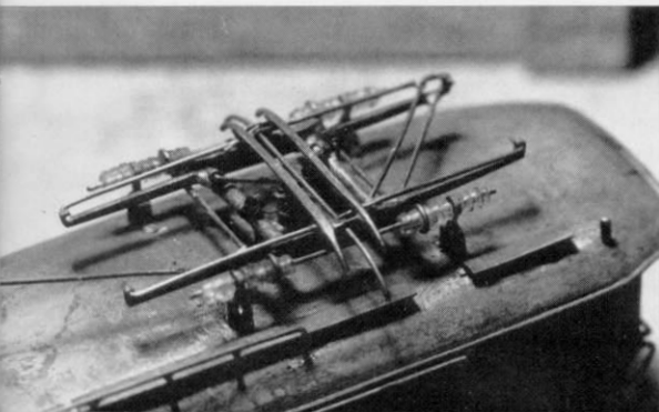
Abb. 7. Der abgesenkte Pantograph; eines der beiden „entspannten“ Federchen des Hebels sieht man links vom Schleifstück.
