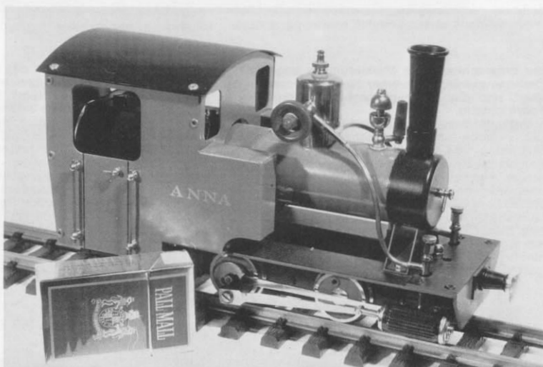
Ilm Abb. 27. Für den Betrieb auf LGB-Gleisen ist dieses mit Butan-gas beheizte "live steam"-Modell einer Bn2-Tenderlok gedacht. Die Regelung der Dampffuhr erfolgt über die Rändelschraube am Dom.
