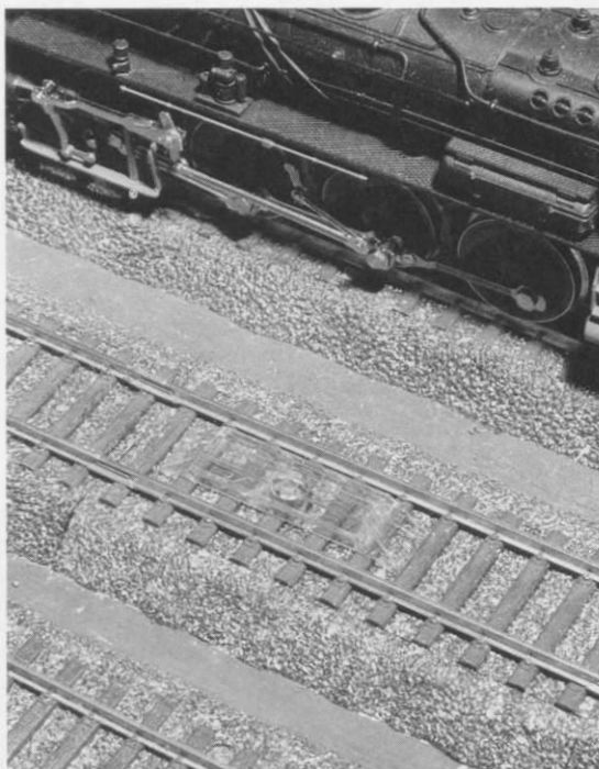
H0 Abb. 54 u. 55. Die Entkupplungsbohle des nunmehr fertigen Conrad-Entkupplungs-Gleisstücks besteht aus Kunststoff und ist in eingebautem Zustand effektiv kaum zu erkennen, wie das gänzlich unretuschierte Bild beweist.
