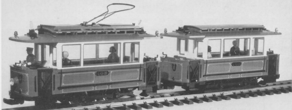
llm Abb. 168. Die gegenüber dem vorjährigen Muster insgesamt verbesserte und nunmehr auch mit dem dazugehörigen Lyra-Stromabnehmer versehene Ausführung der Oldtime-Strab mit offenen Bühnen, sowie der dazu passenden Beiwagen.
