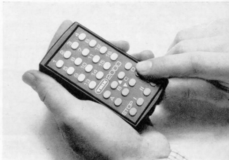
Abb. 2. Der handliche Sender der Fernsteuerung. Die Taster 1–16 betreffen ebenso wie die mit I–III bezeichneten die z. Zt. noch ausstehenden Zusatz-Schaltfunktionen und sollen hier noch nicht interessieren. Mit den jeweils 2 Tastern A–D – obere Reihe hellgrün, untere dunkelgrün – werden die Züge gesteuert (s. Haupttext); der „Stop“-Taster fungiert als Notbremse.
