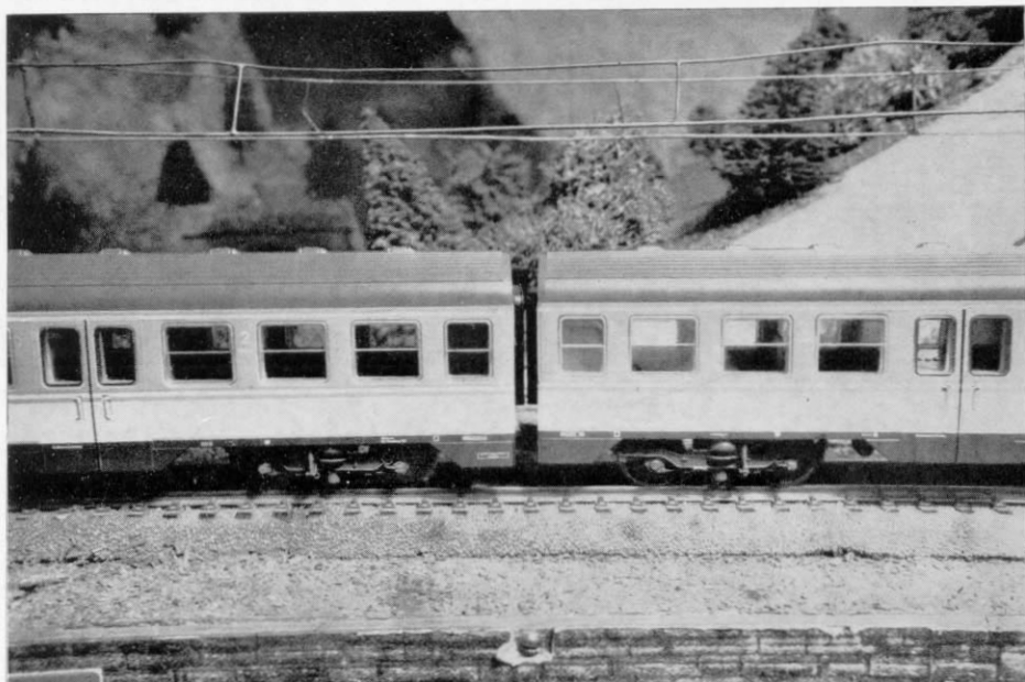
Abb. 1 u. 2. Der Wagenabstand beim Fleischmann-Triebzug 614 mit „hauseigener“ Kupplung (unten) und mit Roco-KK (oben), bei deren Verwendung der Gummiwulst-Abstand nur noch knapp 1 mm beträgt.
