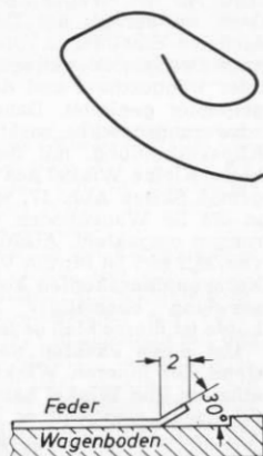
Abb. 15 u. 16. Unmaßstäbliche Darstellung der abzuwinkelnden KK-Feder (oben) und ihrer Position am Wagenboden (s. Haupttext).
