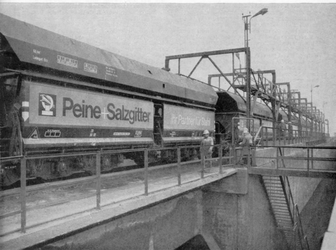
Abb. 10. Um den 4000 Nettotonnen-Zug aus vierzig Fad-150-Wagen in nur zwei Stunden-vollständig entladen zu können, sind natürlich entsprechend dimensionierte Anlagen, Bunker, Förderbänder usw. erforderlich. Hier eine Reihe der neuen Wagen vor der Entladung in Salzgitter-Heerte. (Foto: DB/Schmidt)
