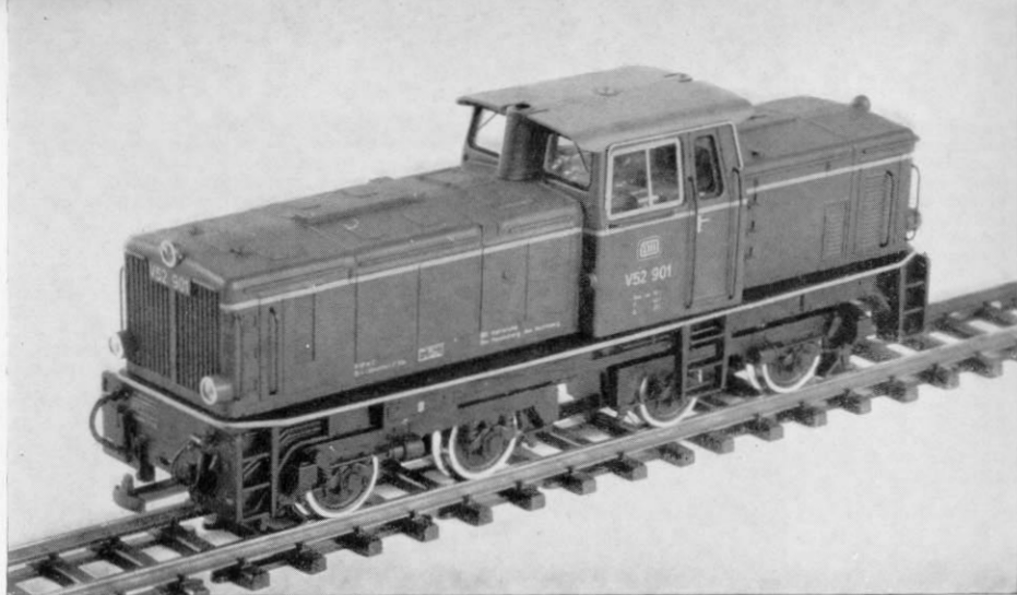
Abb. 5. Das V 52-Modell von Bemo, hier auf dem neuen „haus-eigenen“ 12 mm-Gleis (H0m), das jetzt in Bausatzform ebenfalls im Handel ist. Erfreulicherweise verwehrt der Motor nicht den freien Durchblick durch das Führerhaus (s. a. Abb. 6), dessen Fenster mit vorbildgetreu unterschiedlichen Rahmen versehen sind.
