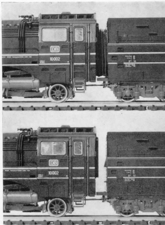
Abb. 7 u. 8. Der Gummiwulst schließt im Großen die Lücke zwischen Führerstand und Tender. Im Kleinen ist jedoch ein größerer Abstand erforderlich, der durch eine dazwischengesetzte Verbindung aus weichfederndem Material (hier ein Rivarossi-Balg) optisch gemindert werden kann.
