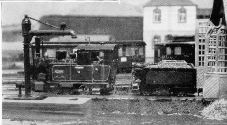
Abb. 3. Die Dampflok „Hoya“ mit dem selbstgebauten zweiachsigen Tender (Aufbauten aus Polystyrol). Der Wasserkran ist von Kibri.
