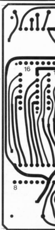
Abb. 3 u. 4 (S. 621 unten). Leiterverlauf für die Vorder- und Rückseite der doppelt beschichteten Platine mit der Gesamtschaltung gemäß dem Blockschaltbild Abb. 1, wiedergegeben in 1/4 Originalgröße.
