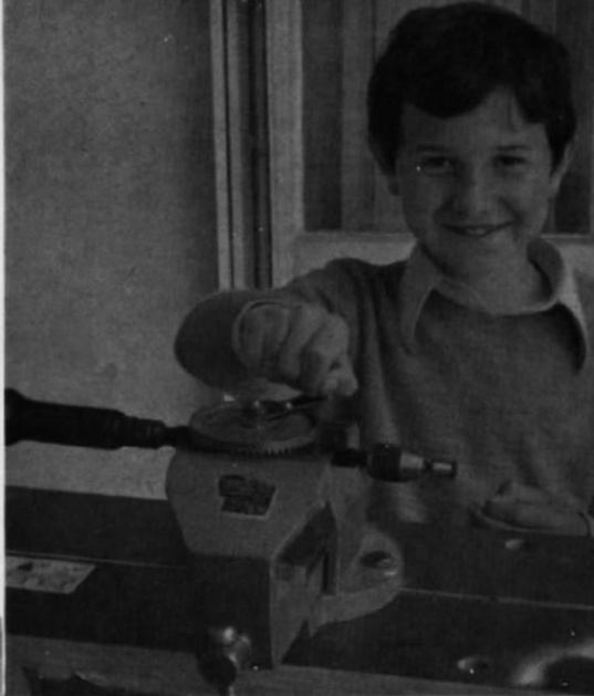
Abb. 3. Die „Spulenwickelmaschine“ des Herrn Belian, „Marke Jean-Paul“. Tja, so einfach geht die Wickelerei vonstatten, und es ist tatsächlich besser, wenn der eine (langsam) dreht und der andere sein Augenmerk auf die Spule richtet, damit möglichst Windung an Windung zu liegen kommt!
