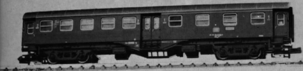
Abb. 4. Das 12,4 cm lange N-Modell des 1./2. Klasse-Umbauwagens vom Typ AByg. Auch am Fahrgestell sind alle Einzelheiten wie Längsträger, Batteriekästen, Bremsanlagen usw. genauestens nachgebildet.
