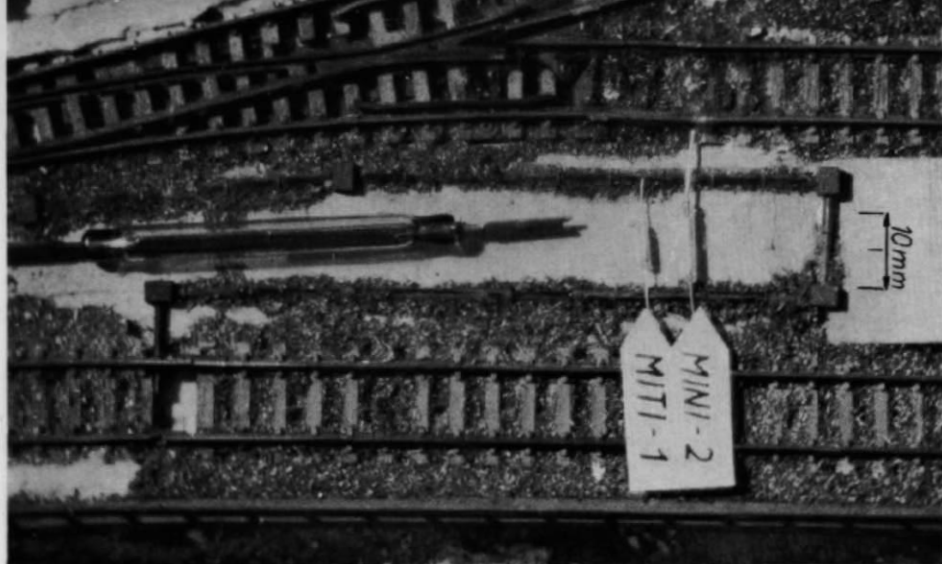
Abb. 1. Die beiden „Winzlinge“ unter den Reed-Kontakten (rechts) im Größenvergleich zu einem „normalen“ Reed-Kontakt (links), demonstrationshalber in eine N-Anlage eingebaut (Wiedergabe in \frac{1}{4} Originalgröße).
