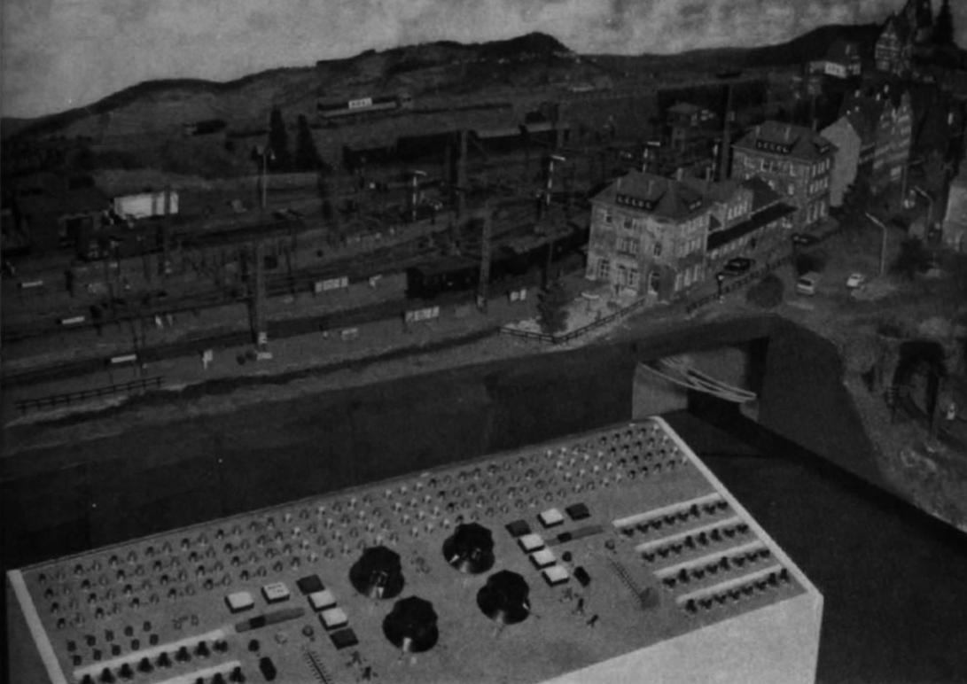
Abb. 7 u. 8. Das selbstgebaute Stellpult, dessen Schaltelemente mit Aufreibebuchstaben gekennzeichnet sind, steht vor dem betrieblichen Mittelpunkt der Anlage, dem Kopfbahnhof. Links und rechts von den vier großen Drehknöpfen sind zwei „minitrone“-Fahrpulte (s. Heft 10-12/73) in das Stellpult integriert eingebaut. Die Kabelverbindung zur Anlage erfolgt über Vielfachstecker. Die „Innereien“ bzw. die Verdrahtung unter dem Bahnhof ist hinter der umschlagbaren Stoffverkleidung zugänglich.
