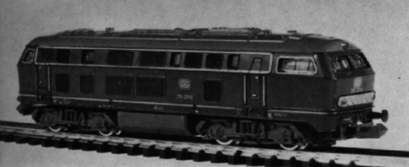
Abb. 3. Das N-Modell der Diesellok BR 215 hat exakt gravierte Dachaufbauten, Lüfterschlitze, Drehgestellblenden usw. Die Zugleistung des auf alle Achsen angetriebenen Modells ist sehr gut.
