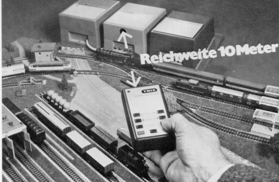
H0 + N Abb. 334. Das „telecontrol“-Handsteuergerät, mit dem drei Fahrpulte drahtlos angesteuert werden können; die Züge werden über Tasten gesteuert (näheres im Rahmen der Messe-Nachlese in Heft 4/77).
