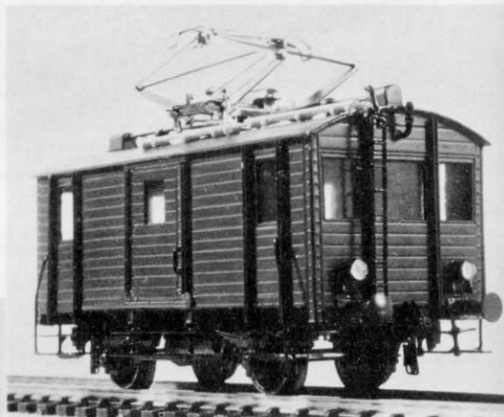
H0 Abb. 219. Das Modell des Ur-Glaskastens PtL 2/2 wirkt mit seinem roten Fahrwerk, dem grünen Aufbau und dem schwarzen Kessel bzw. Dach „in natura“ noch besser. Der Motor füllt außerdem nicht das ganze Führerhaus aus (was bei dieser Perspektive, die die typische Vorbau-Form zeigen soll, nicht herauskommt).
