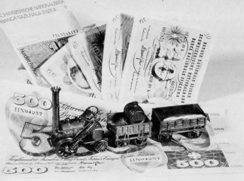
H0 Abb. 239. Eine angemessene „Unterlage“ für das Modell der „Rocket“ wählte WiWeW für diese Aufnahme: den Kaufpreis (650,-) in Schweizer Franken! Der Motor befindet sich in dem Wagen hinterm Tender und wirkt auf beide Achsen. Lok, Tender und Wagen werden in einer Kombination aus Messing-ätz- und Schleudergußteilen hergestellt. Interessenten müssen allerdings noch bis Ende dieses Jahres warten!
