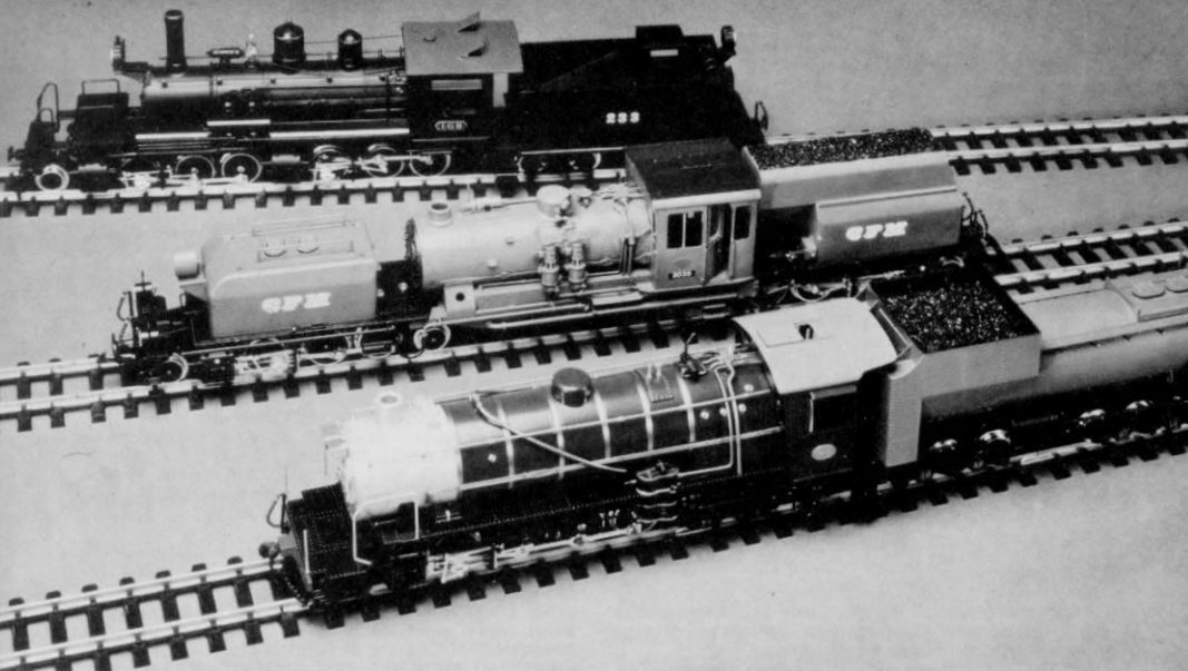
Ilm Abb. 187. Diese drei Kleinstserien-Modelle basieren auf LGB-Fahrwerken, haben handgearbeitete Metallaufbauten und sind nur auf Bestellung lieferbar (die 1'D 2'-Schnellzuglok im Vordergrund noch dieses Jahr, die „Garratt“ nächstes Jahr und die US-„Mallet“ gar erst 1979).
