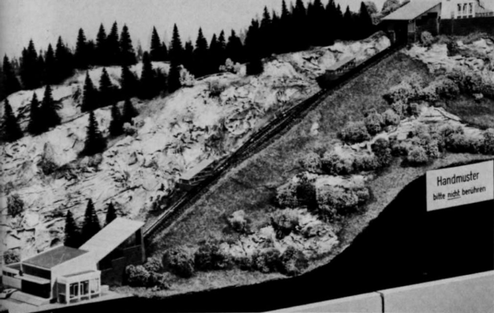
N Abb. 17. Die N-Standseilbahn, deren Gleislänge insgesamt 80 cm beträgt; die in der Mitte befindliche „Abt'sche Ausweiche“ ist 26 cm lang.
