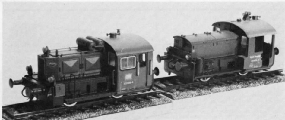
H0 Abb. 99. Und noch zwei Versionen des Kleinlok-Programms: links die neueste DB-Ausführung der Köf II mit zwei Luftkesseln auf dem Motorvorbau, rechts die Akku-Kleinlok der Bauart Ks.
