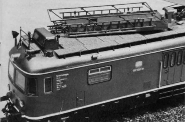
H0 Abb. 101 u. 102. Diese zwei Abbildungen des nunmehr fertigen Turmtriebwegs in Gesamt- und Detailansicht zeigen außer diversen Einzelheiten des Modells (wie dem umklappbaren Bühnengeländer) auch gleich zwei der drei möglichen Ausführungen: das obige Modell gibt die neueste DB-Ausführung in Gelb mit der Beschriftung auf der unteren Hälfte des Wagenkastens wieder, links ein Modell der roten DB-Version mit Computer-Beschriftung in Fensterhöhe.
