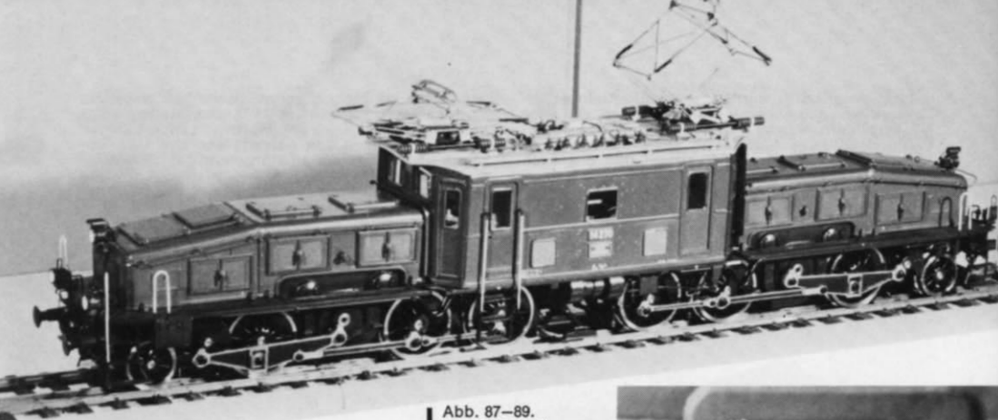
Abb. 87-89. Eine Gesamt- ansicht und zwei Detailansich- ten des 64,7 cm langen I-„Krokodils“, das ferngesteuert heb- und senkbare Pantographen und einen minutiös nachgebildeten Führerstand (samt abschaltbarer Beleuchtung) hat. Preis 11 000,- sFr.
