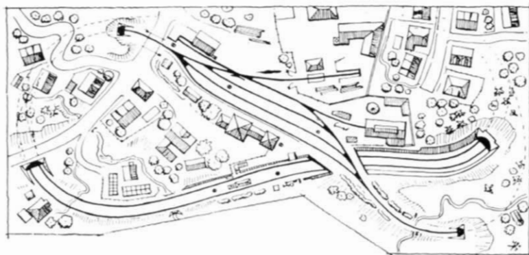
Abb. 2. Dieser Streckenplan-Entwurf (Maßstab 1:40 für H0) aus Pit-Peg's „Anlagen-Fibel“ zu einem Kreuzungsbahnhof zwischen Haupt- und Nebenstrecke gefiel Familie Kaiser so gut, daß sie ihn prinzipiell übernahm; die Abänderungen zeigen Abb. 3 u. 4.
