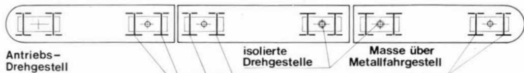
Abb. 2. Schematische Darstellung der Stromabnahme über die einseitig isolierten Radsätze nach Entfernung der Schienenschleifer.
