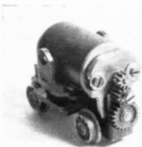
Abb. 4. Das Antriebs-Drehgestell mit neuem Motor und Getriebe (s. Haupttext).
