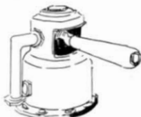
Abb. 5 u. 6. Vorschlag für die Ausführung des Bremsventils nach einem Westinghouse-Vorbild; Seitenansicht und Draufsicht wieder in \frac{1}{5} Originalgröße.
