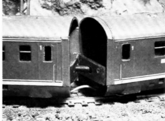
Abb. 7. Der Triebzug auf einem 55 cm-Radius: zwischen den beiden Pufferenden erkennt man die Zugfeder, die so bemessen sein muß, daß sie den Zug gerade zusammenhält, ohne ihn in Kurven durch ihre Steifigkeit zum Entgleisen zu bringen.
