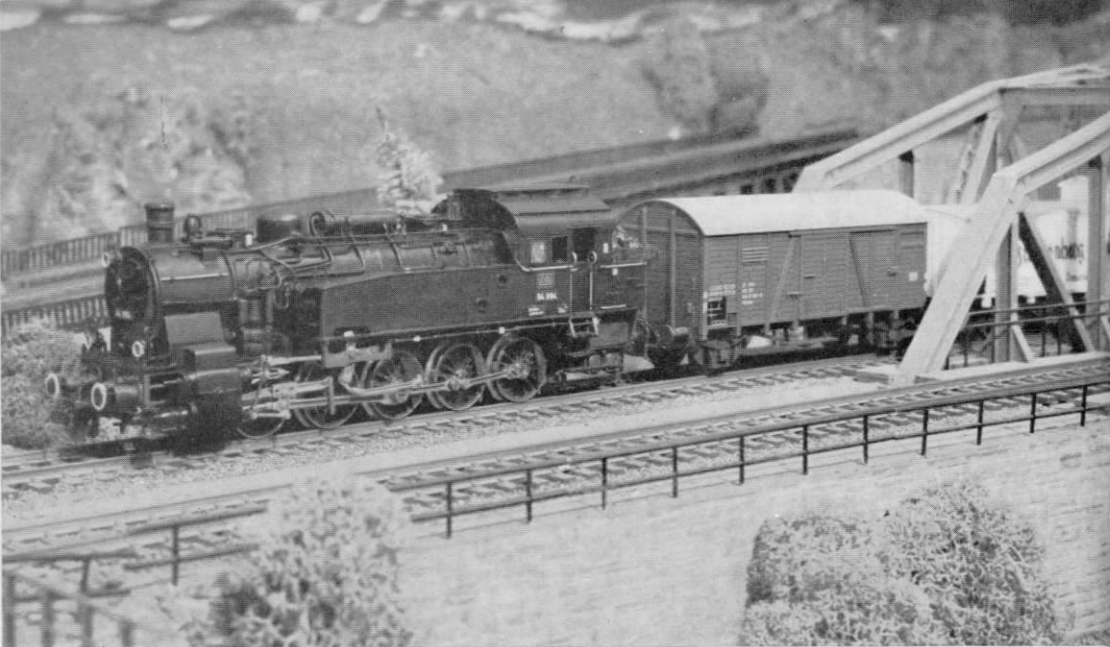
Komplett aus Messing: die BR 94 in H0 , bereits vor Erscheinen des M + F-Modells gebaut von Herrn Helmut Wiehler aus Hamburg (und fotografiert auf der H0-Anlage des Herrn J. Strasser, Hamburg). Das Modell ist mit Elmoba-Rädern ausgestattet und wird über Schneckengetriebe auf die erste und letzte Achse angetrieben.
