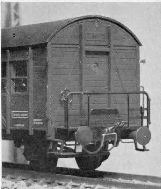
Abb. 1 u. 2. Die Modellkupplung, angebaut an einen MCI-Waggon von Röwa. Auf Abb. 1 ist die „Kupplungshubvorrichtung“ (s. Abb. 4 und 5) angehoben, so daß die — „steif gemachte“ — Kupplung leicht nach oben steht; Abb. 2 zeigt sie in Ruhestellung, also senkrecht nach unten hängend.
