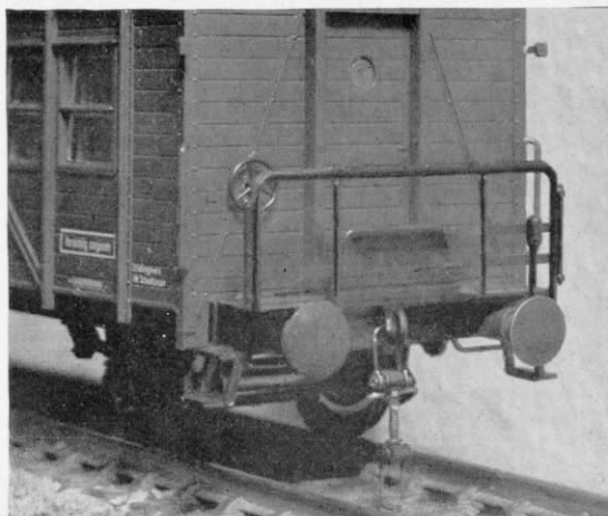
Abb. 1 u. 2. Die Modellkupplung, angebaut an einen MCI-Waggon von Röwa. Auf Abb. 1 ist die „Kupplungshubvorrichtung“ (s. Abb. 4 und 5) angehoben, so daß die — „steif gemachte“ — Kupplung leicht nach oben steht; Abb. 2 zeigt sie in Ruhestellung, also senkrecht nach unten hängend.
