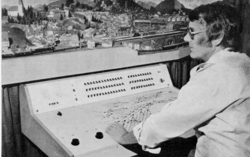
Abb. 1. Rudolf Mangels am Schaltpult seiner N-Anlage. Das selbstgebaute Gleis-Leuchtbild-Stellpult ist fahrbar und läßt sich unter die Anlage schieben.
