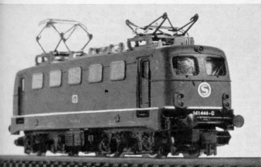
Abb. 2. Das 98,5 mm lange N-Modell der BR 141, hier mit grün/weißem „S“-Schild an der Front, ist mit der Simplex-Rangierkupplung ausgestattet.
