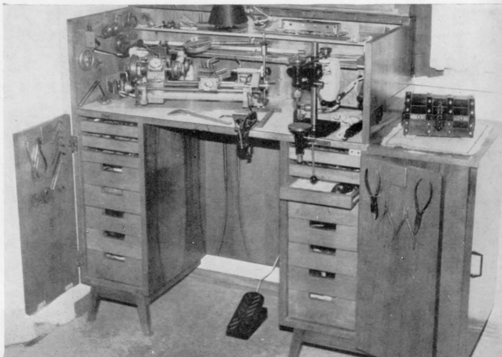
Abb. 1. Der Arbeitsplatz eines Modellbahners – hier der „Arbeitsschrank“ des Verfassers, den ihm seine Frau nach seinen Angaben bauen ließ, damit sie ihren Küchentisch endlich wieder für sich alleine hatte! Außer der komplettierten Drehbank sieht man auch eine Bohrmaschine; diese ist Eigenbau und wurde zur Gänze mit UHU plus geklebt. Als Antrieb dient ein umgepolter Nähmaschinenmotor (90 W). Da die Zugkraft dadurch gelitten hatte, wurden die Bürsten solange versetzt, bis der Motor in beiden Richtungen eine gute Zugkraft hatte. Mittels eines Umpolschalters kann er in die gewünschte Drehrichtung gebracht werden (Gewindeschneiden in Messingblech bis M 3 bzw. 1,5 mm möglich).
