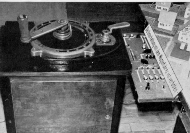
Abb. 1 u. 2. Die beiden umgebauten Original-Fahrschalter an der H0-Strab-Anlage des Herrn Spühr (Heft 1/74). Neben der großen Fahrkurbel sitzt jeweils die kleine Schaltkurbel.
