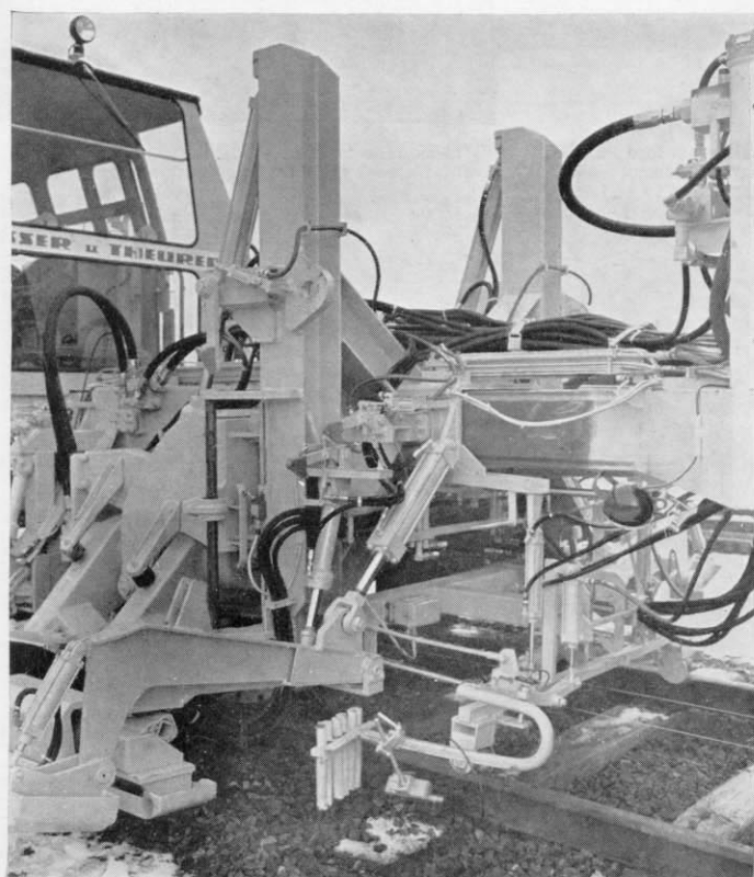
Abb. 13 u. 14. Detailansichten des Vorbilds. Hier erkennt man die wesentlichen Teile von Vorkopfverdichter, Schulteranpreßplatte und Zwischenfachverdichter. Außerdem sieht man die Führung der wichtigsten Hydraulikleitungen.
