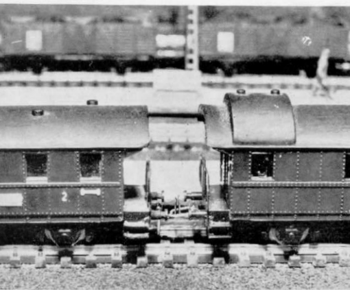
Abb. 1 u. 2. Oben zwei normal gekuppelte Rokal-Wagen, unten zwei nach der Kaupsch-Methode „kurzgekuppelte“ Wagen mit zierlicheren Kupplungen.
