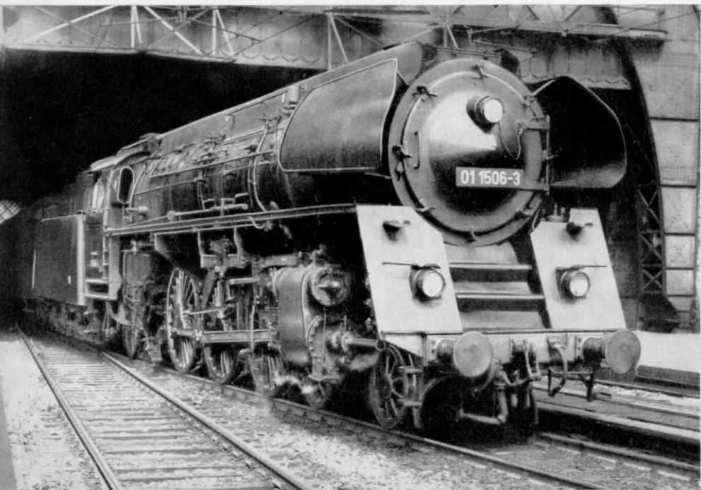
Abb. 13. Nochmals zur Erinnerung ans große Vorbild: die 01 506 mit Normalradsätzen und Domverkleidung, der die Bauzeichnung Abb. 3 im 1. Teil dieses Artikels (Heft 7/76) entspricht. (Foto: „Der Modelleisenbahner“, Berlin)
