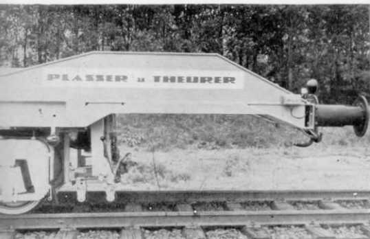
Abb. 3. Seitenansicht der trapezförmigen Längsholme, deutlichkeitshalber in etwa 1/2-facher H0-Größe wiedergegeben. Die etwas überstehenden Deckbleche lassen sich im Modell durch Aufkleben von dünnem Blech (etwa 0,2 mm) nachbilden.
