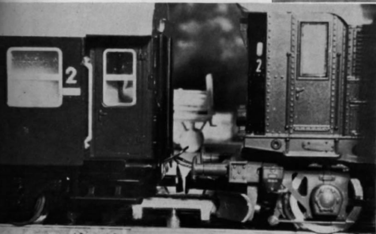
Abb. 1 u. 2. Der angeho-bene Entkuppler, oben „solo“ und links bei der „Trennung“ von zwei Roco-Fahrzeugen. Auf der oberen Abbildung sind deutlich die links und rechts vom Bohlenüber-gang angebrachten „Kupplungsabweiser“ zu erkennen, die im Großen die Bohlen vor Beschä-digungen durch herab-hängende Kupplungen schützen sollen.
