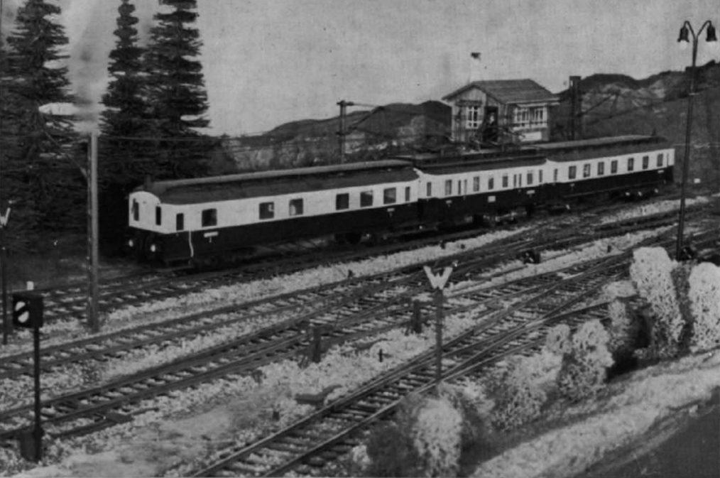
Abb. 2. Ein äußerst beachtliches Erstlingswerk: der ET 87 als O-Modell des Herrn Seide. Die Blenden der Drehgestelle und Einzelachsen sind Kleinserien-Gußteile, die Räder stammen von Heller. Die Pinsellackierung erfolgte mit M+F-Farben; auch die Beschriftung ist handgemalt, während die Klassenschilder kleine Preisschilder sind, wie sie z. B. von Juweliern zur Preisangabe benutzt werden; die kleinste Ausführung paßt genau zur Spur 0. Die Oberleitung ist von Sommerfeldt, das Gleismaterial von Hegob; sämtliche Signale usw. sind selbstgebaut. Die Gleisbettungen sind mit einem scharfen Messer (Abbrechklinge) aus 10 mm-Dämmplatten geschnitten. Innerhalb des Bahnhofsbereichs sind die Bettungszwischenräume mit Gips ausgefüllt.
