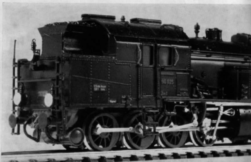
Abb. 2. Hinteres Triebwerk und Führerhaus des Modells; man beachte Details wie die seitlichen Schutzscheiben an den Führerhausfenstern oder die Dampfstrahlpumpe unter dem Führerhaus (etwa über der 2. Kuppelachse).
