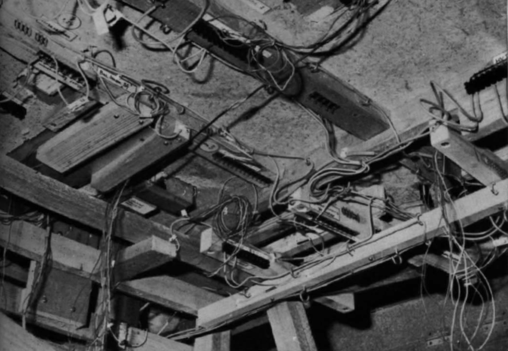
Abb. 5. Ein weiteres Beispiel für die Kabel- und Verteiler-Anordnung unter der Grundplatte. An der etwa durch die Bildmitte von rechts oben nach links unten verlaufenden Leiste erkennt man ein dickes Einzelkabel, das mit Nagelschellen befestigt ist. Auch hier gut zu sehen: die genaue Bezeichnung der diversen Anschlüsse und Verteilerstellen.
