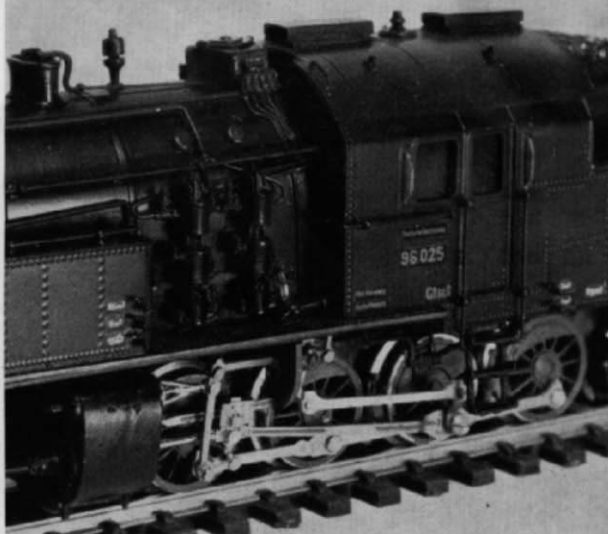
Abb. 3. Zwischen Wasserkasten und Führerhaus setzen auf dem Umlaufblech die Nachbildungen der zwei Bremsluftpumpen, die im Großen bei dieser Ausführung wegen der größeren Bremskraft vorgesehen wurden; Ausführung 1 hat hier nur eine Pumpe. Die drei kleinen „Hähnchen“ am Ende des Wasserkastens sind die genauen Nachbildungen der sog. „Wasserprüfhähnchen“, mit denen im Großen der Wasserstand überprüft wurde.
