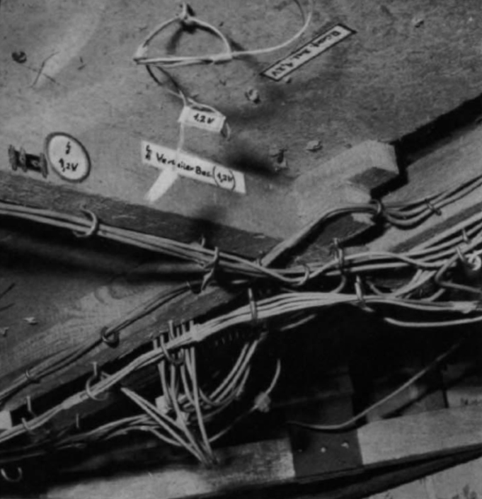
Abb. 7. Zur Vermeidung von Fehlanschlüssen, die zur Zerstörung der empfindlichen 1,2 V-Glühlampen führen würden, sind die entsprechenden Anschlüsse besonders gekennzeichnet. Hier erkennt man diverse Beispiele, so z. B. die rot umrandeten Schilder „Rückf. Bel. 1,2 V“ oder „Verteiler Bel. 1,2 V“; links an der Rahmenleiste ein Warnschild „1,2 V“ im roten Kreis.
