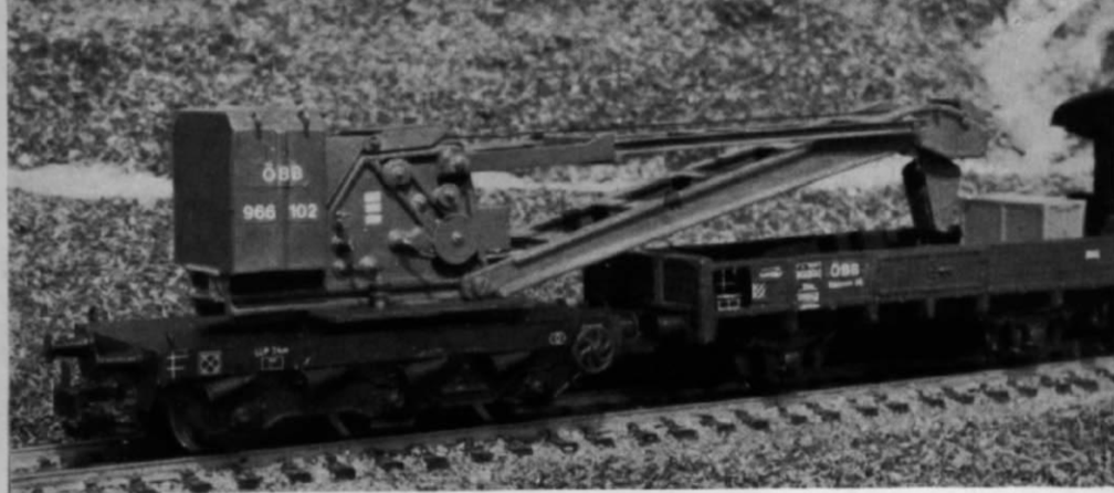
Abb. 10. Das Petrovitsch-Kranmodell in Transportstellung; der Ausleger ragt über den Schutzwagen, ohne jedoch auf diesem abgestützt zu sein. Die Drehmöglichkeit des Aufbaues ist in Mittelstellung blockiert. Der tangential zur Gleisbogenmitte wegstehende Kranausleger bleibt selbst noch auf einem 36 cm-Radius innerhalb des Umgrenzungsprofils nach NEM 102.
