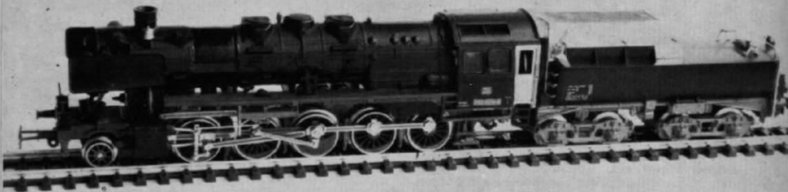
Abb. 4. Die fertige Lok/Tender-Einheit mit den noch unlackierten neuen Teilen. Der vordere Dom ist demontiert (vgl. Abb. 3).
