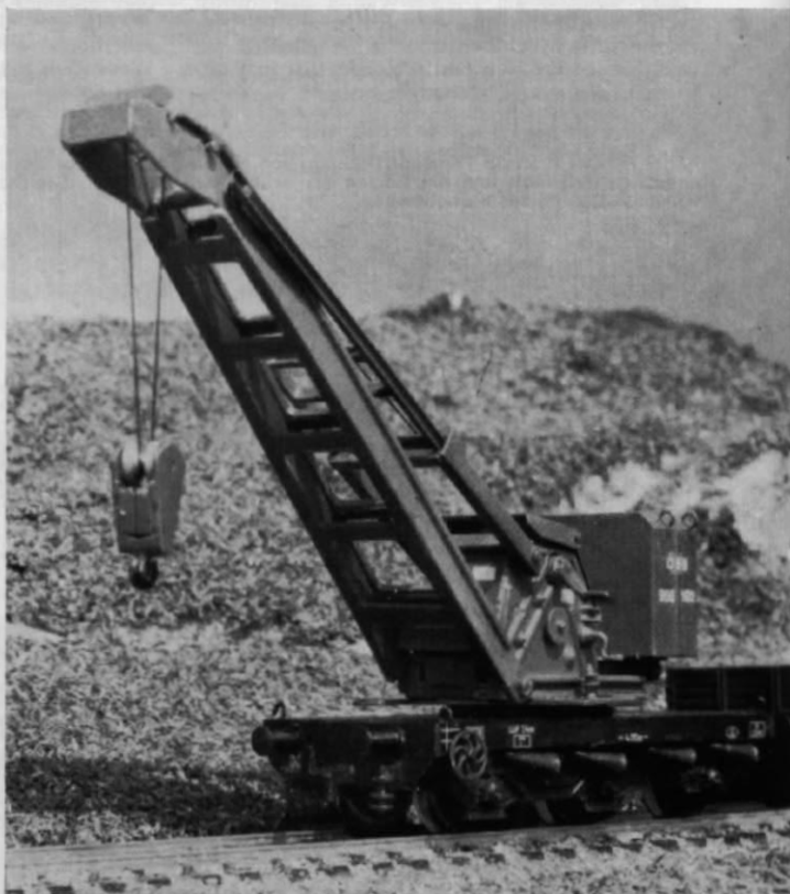
Abb. 8. Der Kranwagen in Transportstellung, aber noch ohne vorgereichten Schutzwagen; unter den Puffern erkennt man die bei Abb. 1 erwähnten Greifzangen. Der Kranausleger besteht aus einer konisch verlaufenden Kastenhohlkonstruktion mit Zwischenquerstegen. Die Auslegerneigung wird dabei durch die jeweils eingestellte Länge der oberen Zugstreben bestimmt, die sich teleskopartig ineinanderschieben und in vier verschiedenen Stellungen mit einem Bolzenmechanismus einrasten können (s. auch Abb. 2).
