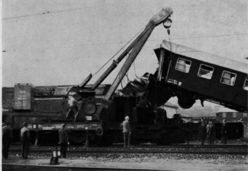
Abb. 1. Der „Hauptakteur“ der heutigen Abhandlung, der dreiachsige Kranwagen, „in action“ nach einem Auffahrunfall: der Kran hebt einen Zweilachser von der Ellok. Der Kran ist hier auf den Schraubstempeln abgestützt, das Gegengewicht ist voll ausgefahren. Die Mannschaft bedient gerade das Drehwerk mittels Handkurbel. Das Hubwerk ist bei den in Österreich verbleibenden Whylen-Kränen nachträglich motorisiert worden.
