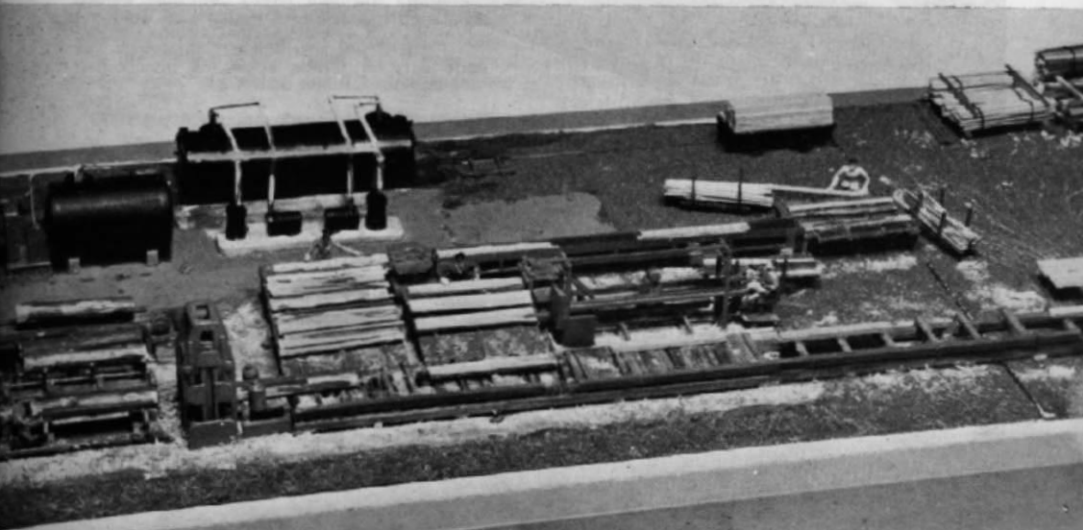
Abb. 5 u. 6. Hier erfolgt das Trennen der seitlichen Abfallstücke (Schwartlinge) von den Schwellenrohlingen (Pos. 5—5b). Die Schwartlinge werden nochmals in schmale Latten zersägt und gelangen über ein Förderband auf kleine Loren, wo sie zusammengepackt werden. Die Schwellenrohlinge werden (obere Abbildung, Bildmitte) nochmals seitlich besäumt und bekommen anschließend die oberen Kanten gebrochen (Pos. 6), wobei das typische Schwellenprofil entsteht (an den winzigen Modell-Schwellen ist dies verständlicherweise nicht nachgebildet).
