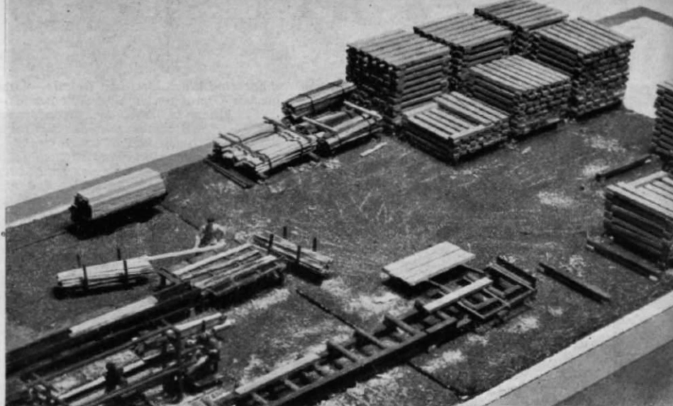
Abb. 7. Das Ende der Förder-Laufrollen für die Schwellen; links daneben werden die Abfallstücke gesammelt und gebündelt. Rechts der Lagerplatz für die noch nicht imprägnierten Schwellen und die Abfallstücke (Pos. 8).
