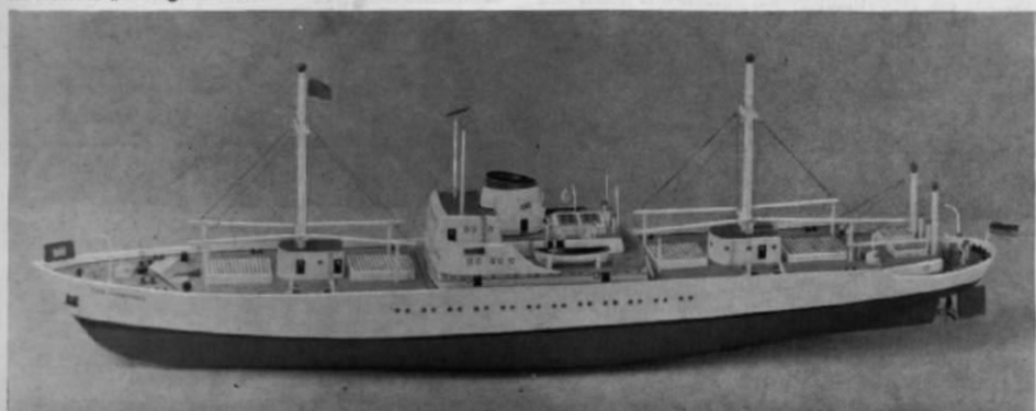
Abb. 4. Mit 1235 mm Länge ein ganz schönes „Trumm“: das 1:100-Modell des modernen Fracht/Fahrtgastschiffes „Cap Domingo“, das von der Fa. Robbe (Metzlos-Gehag, 6424 Grebenhain 1) hergestellt und vertrieben wird. Der Montagekasten enthält einen Kunststoff-Fertigrumpf, tiefgezogene Aufbauten und ausgesägte bzw. ausgestanzte Deckteile; alle weiteren Holzteile sind vorgefertigt oder zugeschnitten. Zusätzlich gibt es Beschlagsätze mit Pollern, Ankern, Bullaugen, Rettungsbooten usw. Neben der „Cap Domingo“ gibt es – gleichfalls im Maßstab 1:100 – noch das ähnliche Frachtmotorschiff „Cap Valiente“ (Länge 1270 mm); dieses Modell wird nicht mehr produziert, aber ca. 100 Bausätze sind noch im Handel „zu ergattern“!
