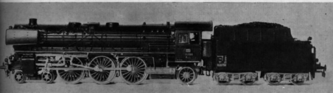
Abb. 1 u. 2. Vergleich zwischen Original-Märklin-01 (oben) und dem Umbau-Modell des Herrn Kaiser. Die augenfälligsten Veränderungen finden sich im Frontbereich (Windleitbleche, Pufferbohle mit freistehenden Lampen) und am Tender (neue Drehgestellblenden, Kohle-Imitation, Aufstiegsleitern usw.). Nicht auf den ersten Blick auszumachen sind dagegen die von der Märklin-03 übernommenen zierlicheren Räder samt Steuerung.
