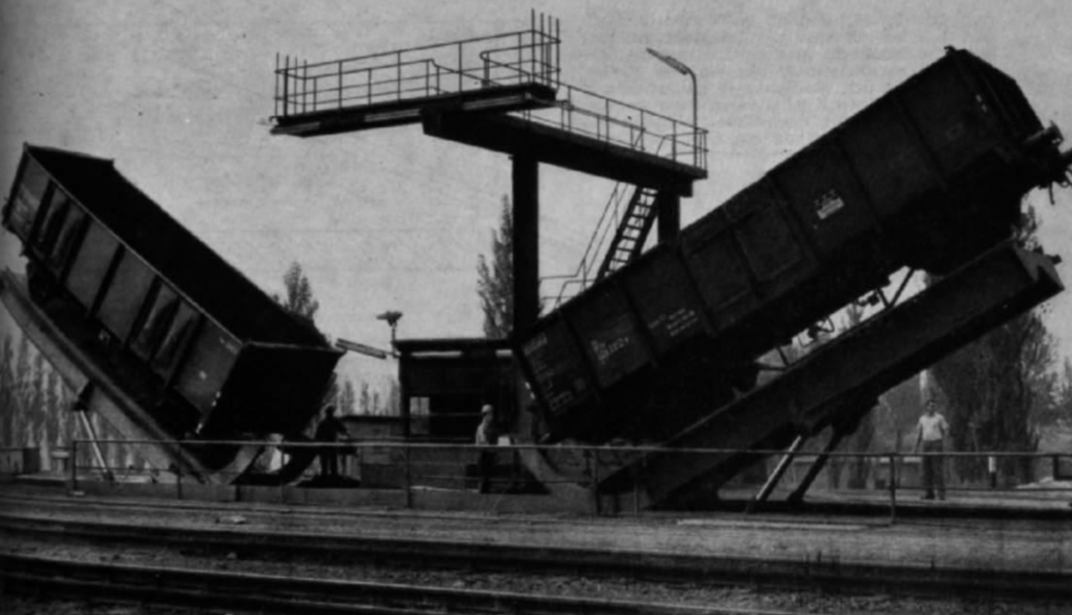
Abb. 10. Der Waggon-Doppelkipper zu Beginn des Hubvorgangs. Noch sind die Stirnwandtüren der Waggon geschlossen; wahrscheinlich klemmen sie etwas und werden erst durch das nachrutschende Schüttgut — in diesem Fall Bauxit — aufgedrückt. (Foto: OSTRA)
