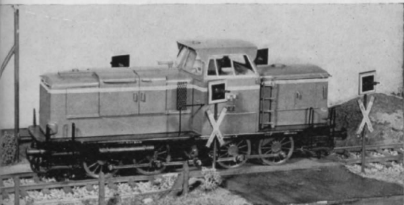
0 Abb. 137. Das 0-Modell der V 65, hier in Privatbahn-Version, ist 246,8 mm lang und mit zahlreichen Details, wie z. B. einer beweglichen Tachowelle, ausgestattet. (Am Bahnübergang übrigens die neue Blinklicht-Garnitur von Markscheffel & Lennartz).
