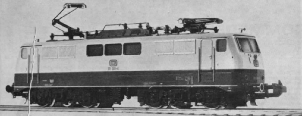
H0 Abb. 239. Das Handmodell der 111, dessen zahlreiche Details (z. B. Nietenimitationen an den Lüfteröffnungen, Regenrinne über den Führerstandsfenstern) auch das Serienmodell aufweisen wird.
