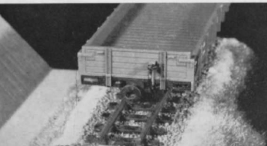
H0e + H0m Abb. 21 u. 22. Links ein H0e-Waggon auf einem 9 mm-Schmalspurgleis, rechts das H0m-Pendant auf einem 12 mm-Gleis; beide Fahrzeuge sind mit der Nachbildung einer Trichterkupplung versehen.
