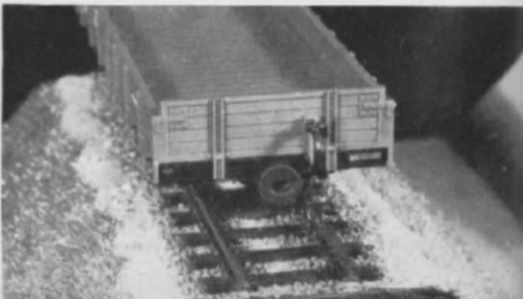
H0e + H0m Abb. 21 u. 22. Links ein H0e-Waggon auf einem 9 mm-Schmalspurgleis, rechts das H0m-Pendant auf einem 12 mm-Gleis; beide Fahrzeuge sind mit der Nachbildung einer Trichterkupplung versehen.
