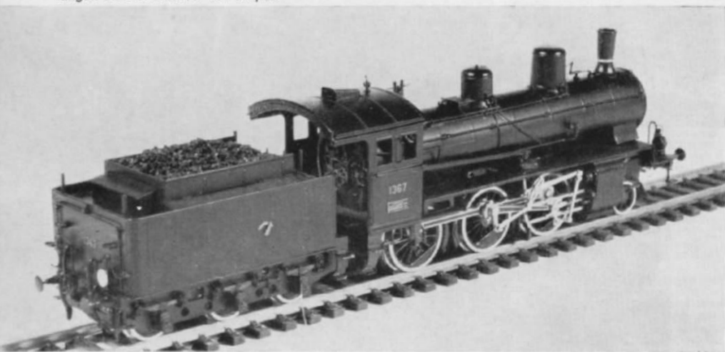
H0 Abb. 73. Obwohl bei diesem Modell der schweizerischen B 3/4 der Motor in der Lok selbst untergebracht ist, ist das Führerhaus freigehalten und eingerichtet. Als Wagengarnitur eignen sich die langen SBB-Zweiachser von Lilliput.
