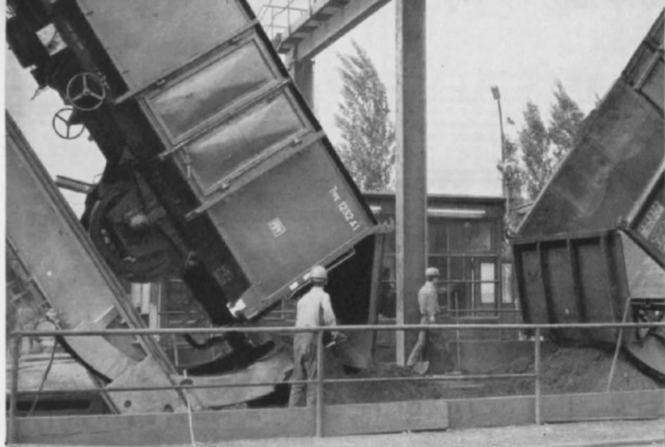
Abb. 8. Detailansicht der Pufferhalter und deren Antrieb. Man erkennt, daß sie sehr schmal (noch schmäler als die Puffer) sind, damit das Ladegut ungehindert hindurchrutschen kann. Teilweise verdeckt durch die oberste Stange des Schutzgeländers sieht man das Antriebszahnrad für die Pufferhalter, links davon einen Teil des Motors. Über dem linken Ende des viertelkreisförmigen Pufferhalters sitzt die an der Bühne angebrachte Führungsstütze; der Pufferhalter rollt zwischen dieser Führung und dem Antriebszahnrad ab.
