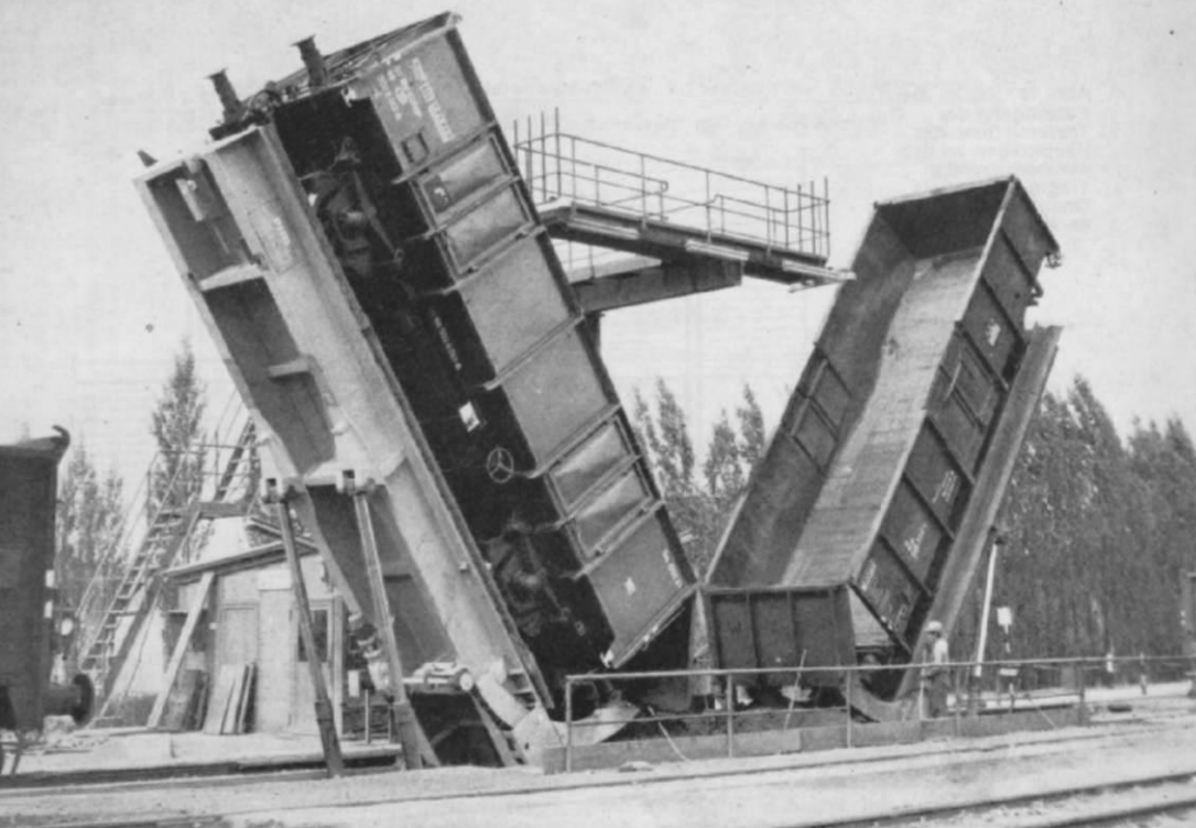
Abb. 1. Zwei Doppelkipper in der obersten Arbeitsstellung; der Entleerungsvorgang ist beendet. Gleichzeitig vermittelt dieses Bild u. a. einen Einblick in die Konstruktionsdetails auf der Unterseite der Kippbühne, die im Modell – wenn man den Pufferhalter mit einem innerhalb der Bühne untergebrachten E-Motor betätigt – eventuell nach unten mit einer Deckplatte abzuschließen ist. Außerdem zeigt diese Abbildung – siehe die Wagen am linken und rechten Bildrand – warum die Pufferhalter versenkbar ausgeführt sein müssen: es werden nicht nur einzelne Wagen, sondern jeweils ein ganzer Zug über die Entladeanlage geschoben. Darüber hinaus muß die Bühne durchgehend befahrbar sein, um auch Mittelselbstentlader (z. B. Fad- oder Talbot-Typen) direkt über der Grube entladen zu können. (Alle Fotos: OSTRA)
