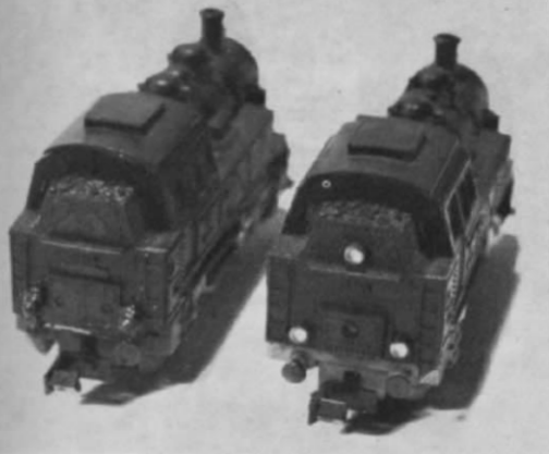
Abb. 2 u. 3. Die werksseitig unbeleuchtete Arnold-BR 80 bekam stirn- und rückseitig eine Beleuchtung aus 2 mm-LED vom Typ CQY 75 „verpaßt“. Auf der rechten Abb. sind die LED und die Zuführungsdrähte deutlichshalber noch nicht eingefärbt; neben der Lok eine 2 mm-LED im Größenvergleich mit einer Münze. Auf der linken Abbildung sind die Zuführungsdrähte schwarz überstrichen; daneben vergleichsweise eine unbeleuchtete Original-BR 80.
