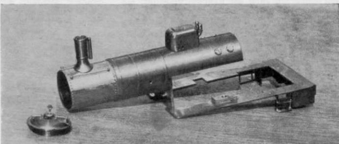
Abb. 22. Der Kessel mit Rauchkammertür sowie das Umlaufblech mit der senkrecht daran angebrachten Platte zur Gehäusebefestigung (siehe Haupttext).
