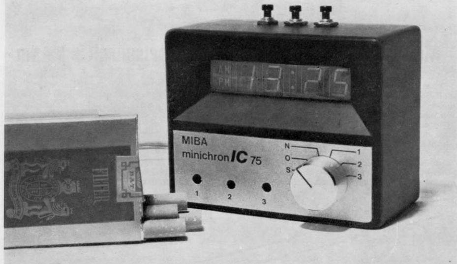
Abb. 1. Die MIBA-minichron IC 75-Modellbahnuhr in ihrem „Fotografier-Gehäuse“ aus (ehemals) weißen ABS-Kunststoffplatten. Nach dem „Verputzen“ wurde das Gehäuse mit mattschwarzem Sprühlack gespritzt; die Frontplatte entstand aus einem Selbstklebe-Schild (im Schreibwarengeschäft erhältlich), das silber gespritzt und mit Letraset-Aufreibebuchstaben beschriftet wurde.
