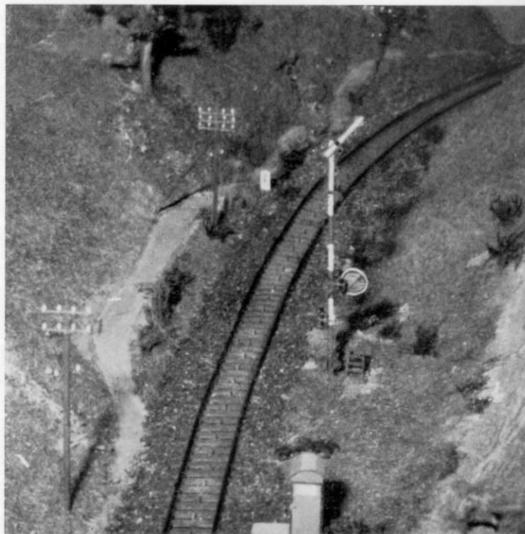
Abb. 8. Das bayerische Einfahrsignal liegt in einer leichten Rechtskurve (hier in der Stellung „Freie Fahrt/Halt erwarten“). Die Kilometersteine bzw. „Abteilungszeichen“ (so die bahnamtliche Bezeichnung) sind aus Holzleisten gearbeitet und ganz bewußt alle 115 cm (= 100 m im Großen) aufgestellt, da nach Meinung des Erbauers eine dichtere Folge nicht gut aussieht und dieser Abstand für die Bestimmung und Einhaltung der Modellgeschwindigkeit zweckmäßiger ist.
