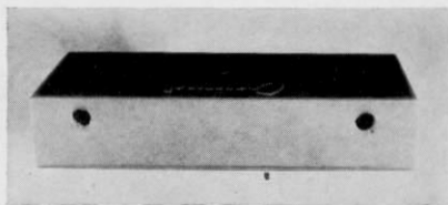
Abb. 16. In der Stirnseite des Bausteins 3200 G sind zwei Bohrungen, durch die man mit einem 2,5 mm-Schraubenzieher die dahinter liegenden Drehwiderstände zwecks Änderung des Brems- (links) bzw. Anfahrweges (rechts) stufenlos verstellen kann. Der Bremsbaustein 3210 G weist keine Bohrung auf – da nicht stufenlos einstellbar –, der Anfahr-Baustein 3220 G nur die rechte.
