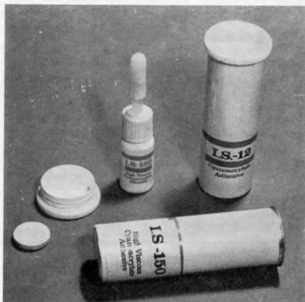
Loctite-Schnellkleber; die Tuben sind 7,5 cm groß und enthalten 2 g Klebstoff. Die Tablette befindet sich in der Blechhülse und absorbiert die Feuchtigkeit der in der Hülse befindlichen Luft.
