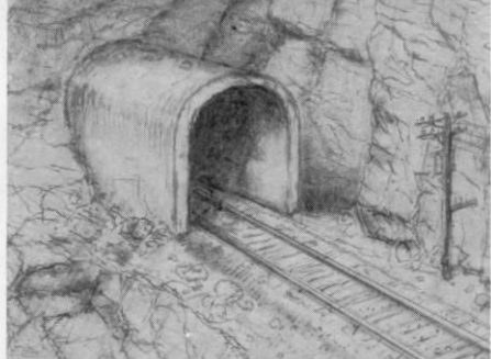
Eine vorgezogene Tunnelröhre aus Beton, wie sie z. B. in Mittelamerika zum Schutz besonders steinschlaggefährdeter Strecken zu finden ist (Skizze vom Verfasser).
