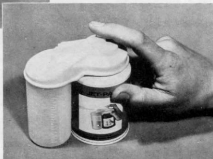
Abb. 2. Die „Jet Pak“-Spritzpistole; an das weiße Kunststoff-Kopfteil lassen sich Treibmitteldose (rechts) und Flüssigkeitsbehälter separat ansetzen.
