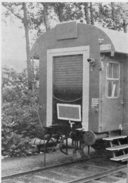
Abb. 4. An der Stirnseite befinden sich der Wasseranschluß (oben links) und die Sh2-Tafel zur Sicherung des abgestellten Wagens.
