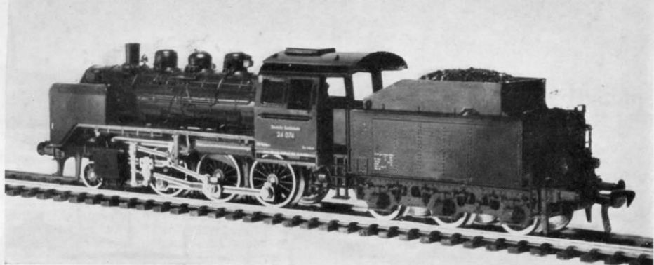
Abb. 4. Das Fleischmann-H0-Modell der BR 24 hat den Motor im dreiaxigen Triebtender; dadurch konnte das Führerhaus völlig freigehalten und mit Führerstandsarmaturen etc. versehen werden.
