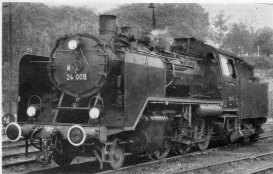
Abb. 1. Die „24 009“, eine der drei betriebsfähigen Dampfloks der Arbeitsgemeinschaft Eisenbahnkurier e. V., Wuppertal (Foto: EK). Die geradezu „zierliche“ Befestigung der Windleitbleche mit nur jeweils einem Eisenstab ist deutlich zu erkennen. Im übrigen meint der „BR 24-Spezialist“ des EK, Herr Kurt Meyer, daß das Fleischmann-Modell eigentlich die Nummer „24 009“ tragen müßte, da es alle Merkmale der ersten Bauserien der BR 24 trägt (kleinere Windleitbleche, einfachere Bremsanlage, 3 T 16-Tender usw.). Nun — wer aus weiteren Unterlagen und Fotos ähnliches zu erkennen glaubt, kann sein Modell entsprechend umbeschriften (z. B. mit den in Heft 6/75 gezeigten Hahmann-Lokschildern).
