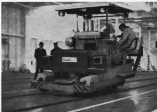
Abb. 9. Eine der speziellen Rangierloks, die auch schienenunabhängig eingesetzt werden können.
