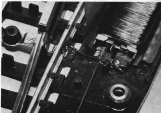
Abb. 2. Damit der Stelldraht Massepotential führt, ist das Ankergehäuse mittels eines Kabels mit der Außenschiene zu verbinden.
