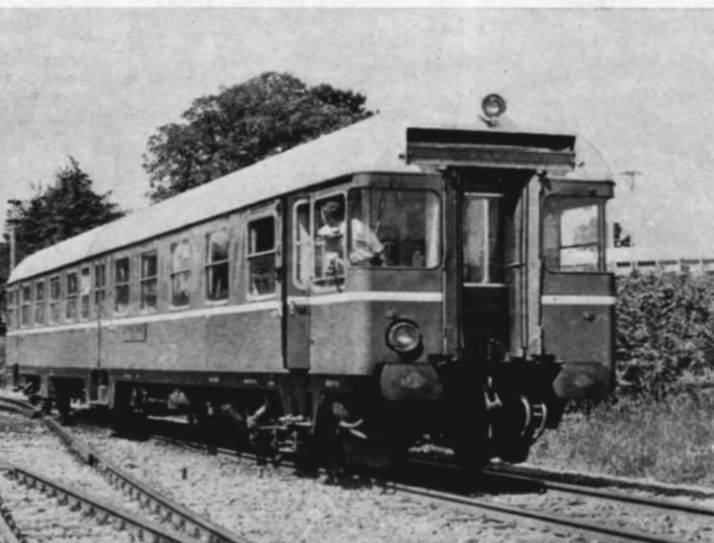
Abb. 2. Der gleiche OHJ-Triebwagen Nr. 25, hier mit in das Dach eingeklapptem oberem Gummiwulst (s. Haupttext).
