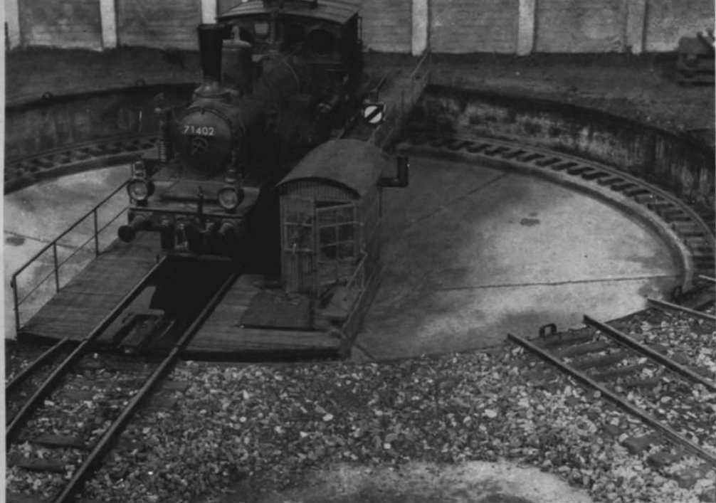
Abb. 1. Immer wieder frappierend: die Modellbau-, Farbgebungs- und Gestaltungskünste des Herrn Fazler! Diese Drehscheibe befindet sich auf seiner in den Heften 12/74 und 4/75 gezeigten Spur I-Anlage; die größte Tiefe der Grube beträgt 9 cm. Das Wellblech des Wärterhäuschens wurde nach dem „Nudelprinzip“ hergestellt – mittels einer nostalgischen „Teigmaschine“, die nach einem entsprechenden Umbau eingefräste Rillen in den gegenläufigen Walzen aufweist.
