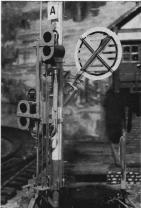
Signal, lässt es sich kaum leichter bauen, da der Detailreichtum zunimmt. Allein die Scheibe besteht aus 19 Einzelteilen. Für die senkrechte Scheibenstellung bzw. ihr waagerechtes Zurückklappen und den genauen Lichtwechsel von Gelb auf Grün ist ein sehr genaues Arbeiten notwendig. Laternen befinden sich wie beim Original auf einem Vorbau. (Alle Fotos vom Verfasser.)
