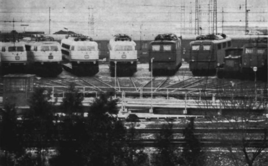
Abb. 32 u. 33. Das ist die Situation im Bw München Hbf: Die Drehscheibe und die Abstellgleise sind nicht mit Oberleitung überspannt. Die Ellok werden mit Köf-Kleindieselloks (wobei die Pantographen natürlich abgesenkt sind) verschoben. (Fotos Abb. 1 u. 2: Heinz Obermayer, München).
