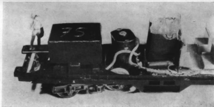
Abb. 3. „Heinrich mit dem großen Hammer“ hat das Drehgestell ausgebaut, um den MIBA-Lesern das Antriebsprinzip zu zeigen: Der Minitrix-Motor ist senkrecht mittels Stabilität und Plastikstückchen befestigt; seine Schnecke wirkt auf das Zahnrad der Antriebsachse. Die Stromzuführung erfolgt über (leider nicht erkennbare) Federbronze-Streifen.
