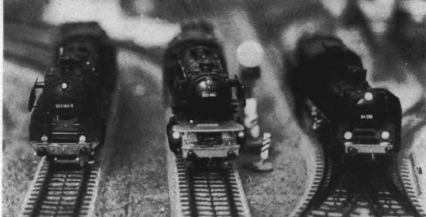
Abb. 5. Die Lichtwirkung der umgebauten BR 23 (Mitte) im Vergleich zu einer Märklin-24 älteren Herstellungsdatums (rechts) und der BR 03 aus dem Jahre 1973 mit deutlich kleinerer, vorbildnäherer Stirnbeleuchtung.
